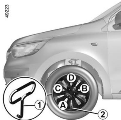
Déposez-le à l'aide de la clé d'enjoliveur **1**, (située dans le bloc outils) en engageant le crochet dans l'ouverture prévue à proximité de la valve **2**.
