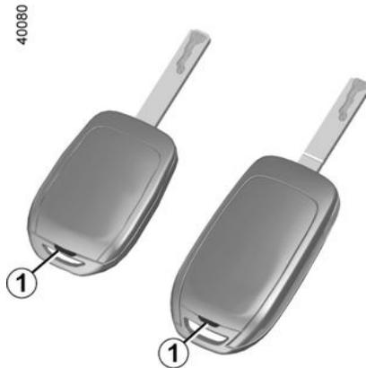
Ouvrez le boîtier par la fente **1**, à l'aide d'un outil type tournevis plat, et remplacez la pile **2** en respectant le modèle et la polarité gravée sur le fond du couvercle.
