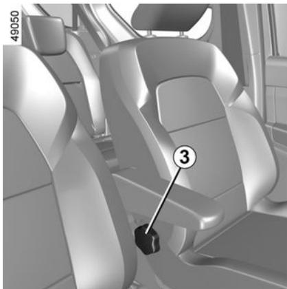
Tournez la molette **3**, ou, suivant véhicule, tirez la manette **4**, pour incliner le dossier jusqu'à la position désirée et assurez-vous du bon verrouillage.
