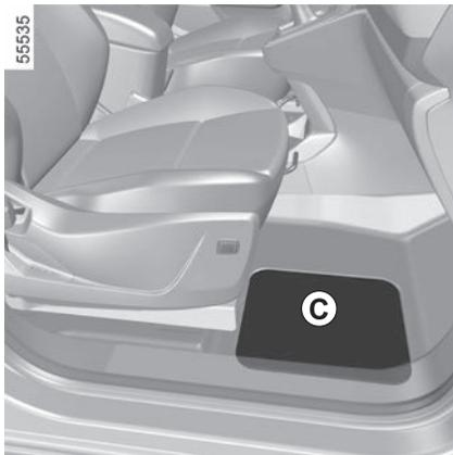
Suivant véhicule, en cas de crevaison, utilisez le kit situé dans le rangement sous la trappe **C**, aux pieds d'occupant du siège avant côté droit.
