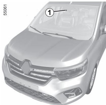
À partir des informations provenant de la caméra **1**, la fonction se déclenche par une action corrective sur le système de direction du véhicule en cas de franchissement d'une ligne (continue ou discontinue) sans avoir activé l'indicateur de direction.
