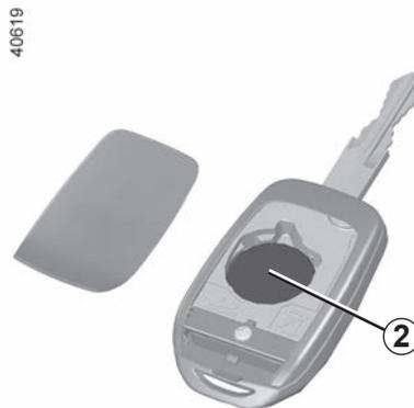
**Nota :** lors du remplacement de la pile, veillez à ne pas toucher au circuit électronique situé dans le couvercle de clé.
