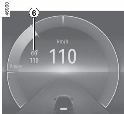
Lorsque le limiteur est mis en veille, un appui sur le contacteur **3** réactive la fonction sans tenir compte de la vitesse mémorisée : c'est la vitesse à laquelle roule le véhicule qui est prise en compte.
