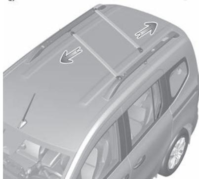
Lors de la manipulation, veillez à ce que les barres ne touchent pas le toit du véhicule : risque de rayer le toit.
