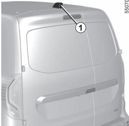
A la mise sous contact du véhicule, l'écran **2** fixé sur la console centrale de pavillon affiche l'environnement arrière transmis par la caméra **1**.
