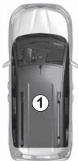
La carte doit être dans la zone de détection **1** ou, suivant véhicule, dans la zone de détection **2**.
