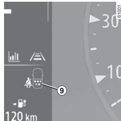
Lorsque la vitesse du véhicule est supérieure à 20 km/h, si l'une des ceintures arrière est, ou devient débouclée pendant le trajet :
