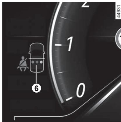
Lorsque la vitesse du véhicule est, ou devient supérieure à 20 km/h, si l'une des ceintures arrière est débouclée pendant le trajet :
