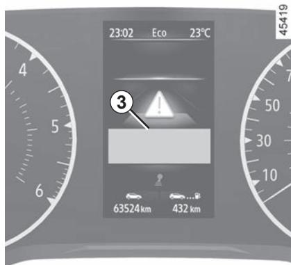
Si le freinage actif d'urgence a provoqué l'arrêt du véhicule, le maintien du véhicule à l'arrêt doit être réalisé par le conducteur en maintenant son pied sur la pédale de frein.
