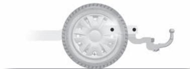
Un dispositif d'attelage ne doit pas masquer un élément d'éclairage ou la plaque d'immatriculation lorsqu'il n'est pas utilisé. Les dispositifs d'attelage mécanique (rotule, crochet...) démontables sans outils ou escamotables doivent être enlevés ou repositionnés lorsqu'ils ne sont pas utilisés.
