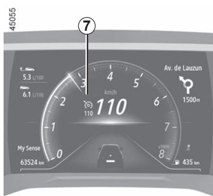
L'extinction du témoin **7** au tableau de bord confirme l'arrêt de la fonction.
