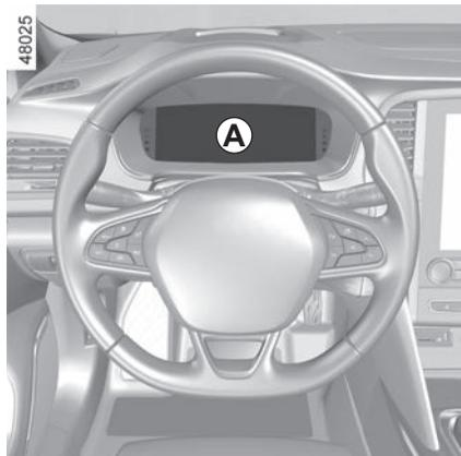
**Tableau de bord A, B, C ou D** : Il s'éclaire à l'ouverture de la porte conducteur.
