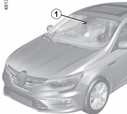
Le système détecte les panneaux de limitation de vitesse sur le bord de la route et les affiche au tableau de bord.
