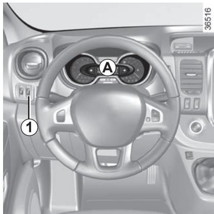
**Tableau de bord A** : Il s'éclaire à la mise sous contact. Vous pouvez en régler l'intensité lumineuse en tournant la molette **1**.
