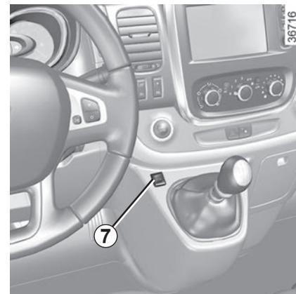
**Véhicules équipés du mode ECO (contacteur 7) :** lorsqu'il est actionné, le mode ECO peut diminuer les performances du chauffage et/ou de l'air conditionné. Reportez-vous au paragraphe « Conseils de conduite, Eco conduite » en chapitre 2.
