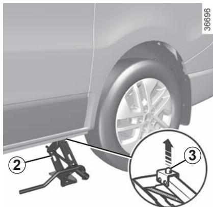
Présentez le cric **2** horizontalement, le téton **3** de la tête du cric doit coïncider avec le trou prévu dans la partie inférieure de la carrosserie et le plus proche de la roue concernée.
