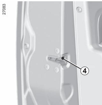
L'ouverture ne pourra alors se faire que de l'intérieur du véhicule ou par la clé pour les portes avant.
