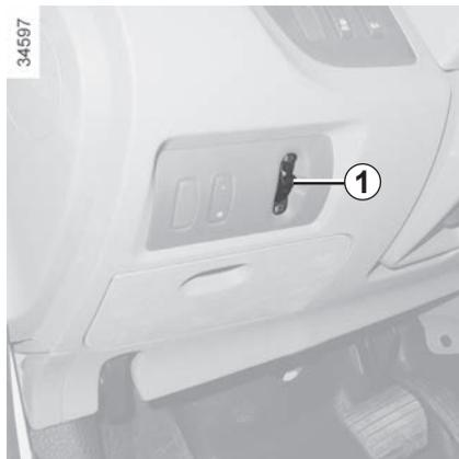
La molette **1** permet de corriger la hauteur des faisceaux en fonction de la charge.
