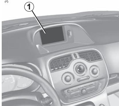
**Nota :** suivant véhicule, l'écran 1 permet de visualiser l'environnement du véhicule en complément des signaux sonores.
