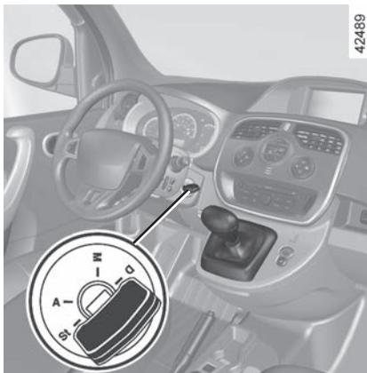
Avant tout remorquage, insérez la clé dans le contacteur pour déverrouiller la colonne de direction. Tournez-la en position **M**.
