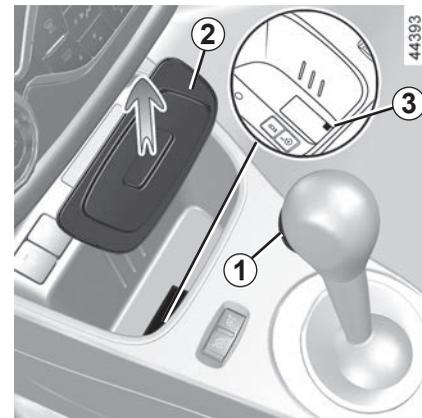
Dans le cas où le levier est bloqué sur **P** alors que vous appuyez sur la pédale de frein et sur le bouton de déverrouillage **1**, il y a possibilité de libérer manuellement le levier. Pour cela, enlevez le tapis **2** du fond du rangement pour accéder au levier de déverrouillage **3**. Ensuite, relevez le levier **3** et appuyez simultanément sur le bouton de déverrouillage **1** situé sur le levier.
