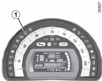
Lorsque le véhicule en est équipé, en roulage, ce système avertit de la perte de pression d'un ou plusieurs pneumatiques.
