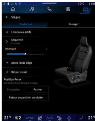
Véhicule à l'arrêt, vous pouvez reculer et incliner le siège conducteur afin d'avoir une position relaxante durant un temps de pause en appuyant sur « Activer ».
