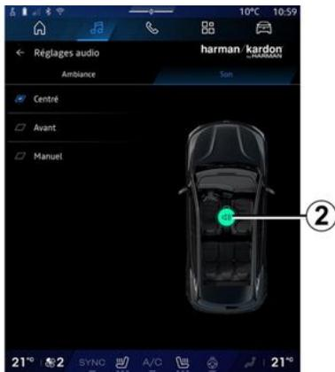
Cette fonction permet de paramétrer la répartition du son. Appuyez sur « Centré » ou sur « Avant » afin d'optimiser la distribution du son pour tous les occupants du véhicule ou pour le confort des passagers arrière (son coupé à l'arrière et volume modéré à l'avant du véhicule).
