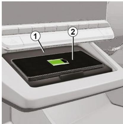
La zone de charge d'induction **1** permet de charger un téléphone sans le connecter à un câble de chargement.
