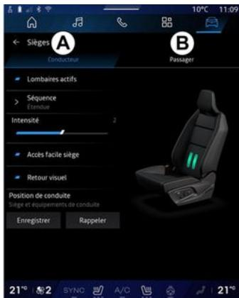
Depuis le Monde « Véhicule »
