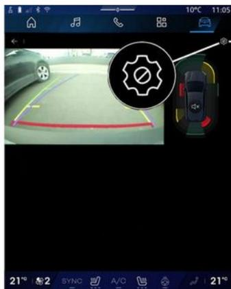
Au passage de la marche arrière, la caméra de recul située à l'arrière du véhicule s'active afin de transmettre une vue de l'environnement arrière du véhicule sur l'écran multimédia.
