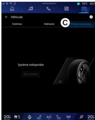
Ce menu permet de contrôler l'état de pression des pneumatiques de votre véhicule et de lancer une réinitialisation.
