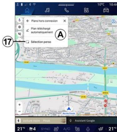
Les plans hors connexion vous permettent de télécharger et d'enregistrer des plans dans votre système multimédia afin de pouvoir les utiliser lorsque vous vous rendez dans un endroit où la connexion internet est lente, inaccessible ou que vous ne souhaitez pas utiliser de connexion internet.
