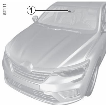
À partir des informations provenant de la caméra **1**, la fonction se déclenche par une action corrective sur le système de direction du véhicule en cas de franchissement d'une ligne (continue ou discontinue) ou à l'approche d'un bord de route (terre-plein, barrière, trottoir, talus...) sans avoir activé les feux indicateurs de direction.
