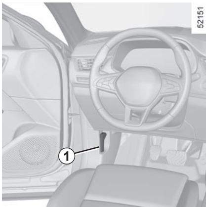
Pour ouvrir le capot, ouvrez une porte et tirez sur la poignée **1**, située du côté gauche de la planche de bord.
