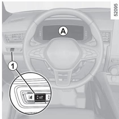
**Tableau de bord A** ou **B** : il s'éclaire à la mise sous contact. Appuyez ou levez le contacteur **1** autant de fois que nécessaire pour régler l'intensité.
