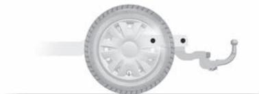
Tout dispositif de remorquage ne doit pas obstruer un élément d'éclairage ou la plaque d'immatriculation lorsqu'il n'est pas utilisé.
