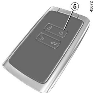
Si la carte se trouve dans la zone de détection **3** depuis environ 15 minutes, le verrouillage à distance est désactivé. Pour verrouiller le véhicule, appuyez sur le bouton **2** sur la poignée **1** selon le véhicule ou le bouton **5** de la carte.
