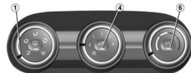
Appuyez sur le bouton **4** : le témoin intégré s'allume. Dans ces conditions, l'air est pris dans l'habitacle et il est recyclé sans admission d'air extérieur.
