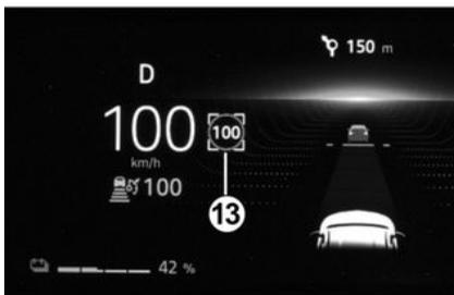
Lorsque la nouvelle limite de vitesse est détectée, le système peut proposer la vitesse détectée au conducteur :
