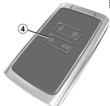
Un appui sur le bouton **4** allume les feux de croisement et l'éclairage extérieur pendant environ 20 secondes. Cela permet, par exemple, de repérer de loin le véhicule stationné dans un parking.
