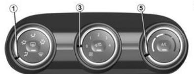
Déplacez la commande **3**. Plus la commande est positionnée vers la droite, plus la quantité d'air pulsé est grande. Si vous désirez arrêter l'arrivée d'air, placez la commande **3** sur « 0 ».
