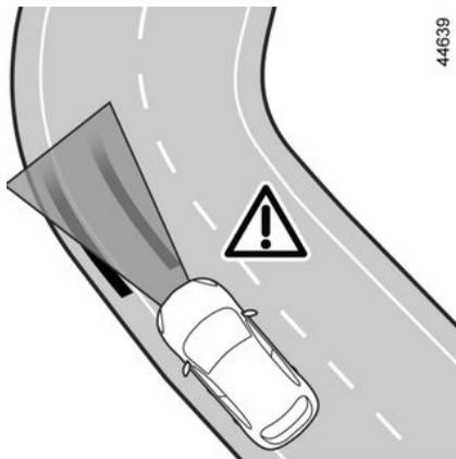
Dans le cas d'une bande vive, et en fonction de la vitesse du véhicule, les capacités de rétention latérale de la fonction seront limitées et imposeront au conducteur une action immédiate sur le volant, afin que la fonction puisse maintenir le véhicule au centre de la voie.
