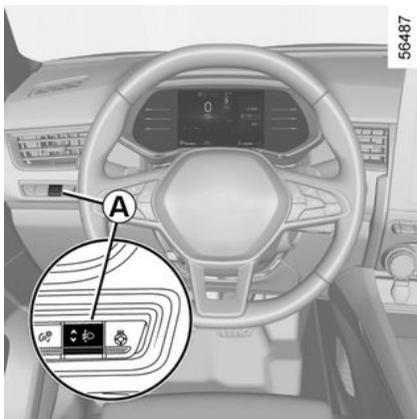
Le contacteur **A** permet de régler la hauteur des faisceaux en fonction de la charge.
