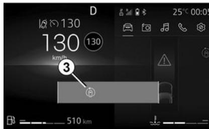
Si le véhicule s'arrête en raison d'un freinage actif d'urgence, le conducteur doit maintenir le véhicule immobile en enfonçant la pédale de frein.
