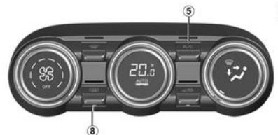
Appuyez sur le bouton **8** : le témoin intégré s'allume. Cette fonction permet un désembuage rapide de la lunette arrière et le dégivrage des rétroviseurs (pour les véhicules qui en sont équipés).
