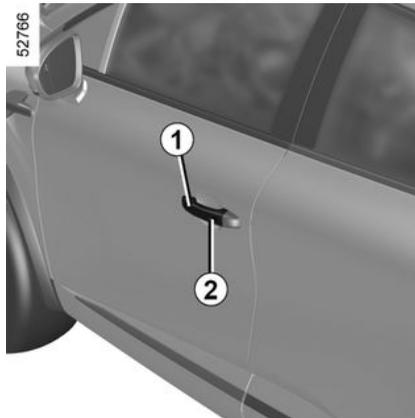
Avec la carte dans la zone **3** et le véhicule verrouillé, appuyez sur le bouton **2** sur la poignée **1** d'une des deux portes avant selon le véhicule : le véhicule se déverrouille. Un appui sur le bouton **2** déverrouille également tout le véhicule.
