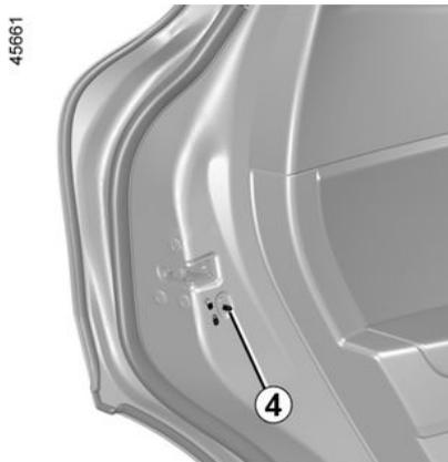
Pour rendre impossible l'ouverture des portes arrière de l'intérieur, déplacez le levier **4** et vérifiez de l'intérieur que les portes sont bien condamnées.
