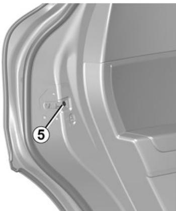
Porte ouverte, faites pivoter la vis **5** (à l'aide de l'embout de la clé) et fermez la porte.
