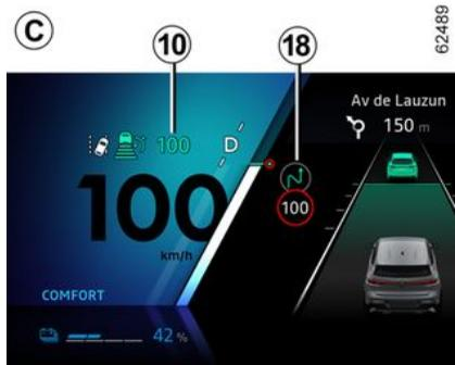
À l'aide de la caméra, de la fonction « Détection de panneaux de signalisation routière » → **232**, et de la cartographie souscrite avec l'abonnement, le système peut anticiper et gérer l'adaptation automatique de la vitesse de régulation **10**, lorsque le véhicule aborde un rond-point ou un virage.
