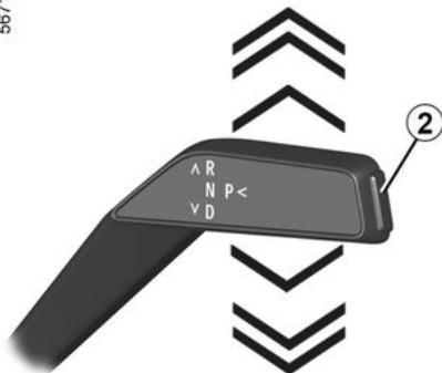
Basculez le levier de sélection **1** d'un cran ou de deux crans vers le haut ou vers le bas pour engager la position désirée (R, N ou D) puis relâchez le levier, il revient dans sa position stable.
