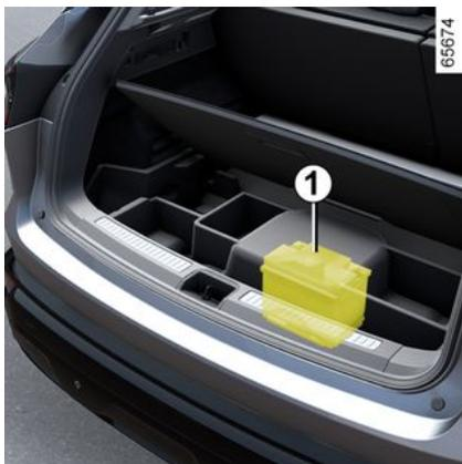
Suivant véhicule, la batterie **1** se trouve dans le coffre du véhicule → **22**.
