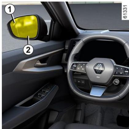
À l'ouverture d'une porte, lorsqu'un objet en mouvement est détecté, le témoin d'avertissement **1** s'affiche sur le rétroviseur extérieur **2** et, suivant véhicule, les lumières d'ambiance présentes dans la porte avant s'allument.
