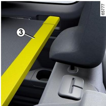
Suivant véhicule, il est nécessaire de positionner le cache-bagages **3** dans sa position la plus reculée pour monter/descendre les appuis-tête arrière.
