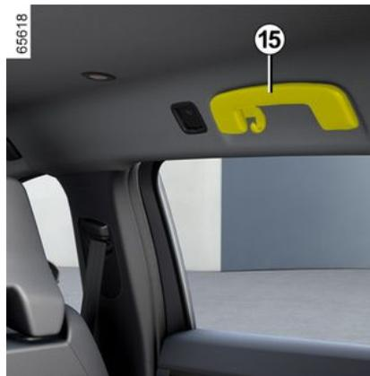
Elle sert à se maintenir en roulage. Vous pouvez l'utiliser pour monter dans le véhicule ou en descendre.
