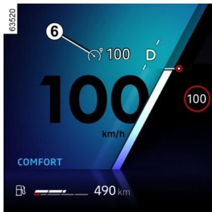
**i** Pour quitter les assistances de conduite, appuyez autant de fois que nécessaire sur le contacteur **1** jusqu'à OFF. Le message « Driving Assistance désactivé » s'affiche au tableau de bord. Dans ce cas, au prochain démarrage moteur, la fonction « Limiteur de vitesse » sera en service et en attente de l'enregistrement d'une vitesse de limitation.
