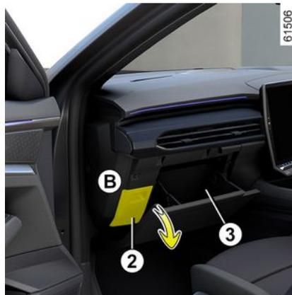
Les fusibles sont situés derrière une trappe 2 dans la boîte à gants 3.
