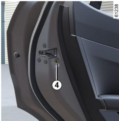
Pour rendre impossible l'ouverture des portes arrière de l'intérieur, déplacez le levier **4** et vérifiez de l'intérieur que les portes sont bien condamnées.
