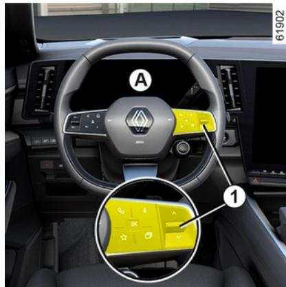
L'affichage sélectionné sur l'un des paramètres de voyage, effectuez un appui long sur le contacteur **1** jusqu'à la mise à zéro de l'affichage.
