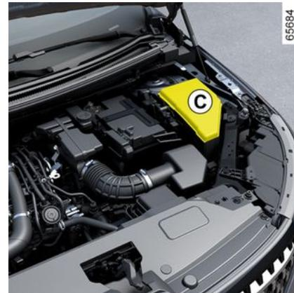
Certaines fonctions sont protégées par des fusibles situés dans le compartiment moteur dans le boîtier **C**.
