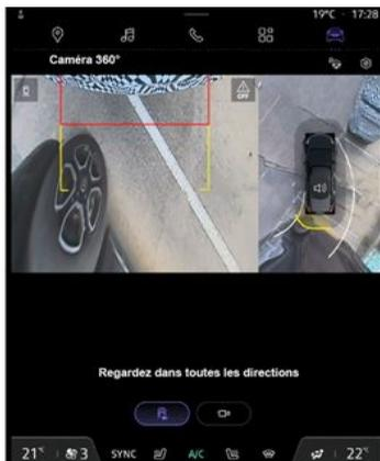
En cas de détection d'un obstacle à proximité de l'avant ou de l'arrière du véhicule, la fonction « Zoom auto » fait basculer l'affichage en cours vers un affichage spécifique (vue de haut, avant ou arrière).
