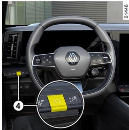
Pour déclencher l'ouverture du hayon, faites un appui long sur le contacteur **4** jusqu'au signal sonore puis relâchez le contacteur.
