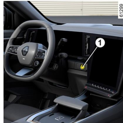
Appuyez sur le contacteur **1** sans appuyer sur les pédales pour la mise sous contact du véhicule. Appuyez sur la pédale de frein puis appuyez sur le contacteur **3** : le témoin **2** du contac-
