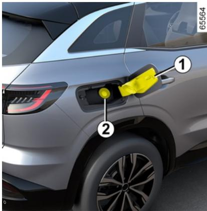
Le clapet **2** est intégré au conduit de remplissage.
