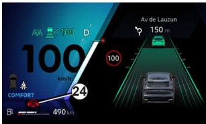
Lorsque la fonction « Centrage dans la voie » ne détecte plus la présence de vos mains sur le volant, plusieurs niveaux d'alerte vont être effectués :
