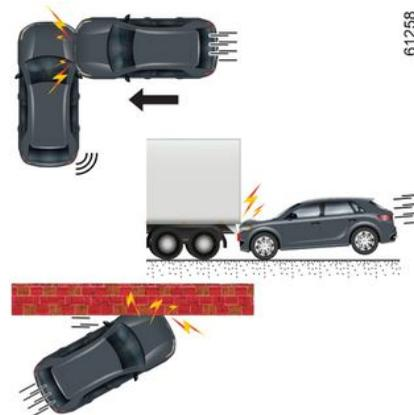
**Dans les exemples de cas suivants, les prétensionneurs ou les airbags sont susceptibles d'être déclenchés :**
