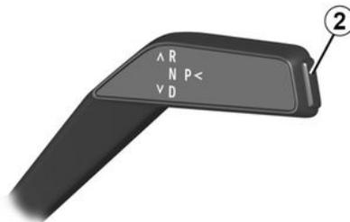
Véhicule à l'arrêt, moteur allumé ou contact mis, appuyez sur le bouton **2** pour engager la position **P**.
