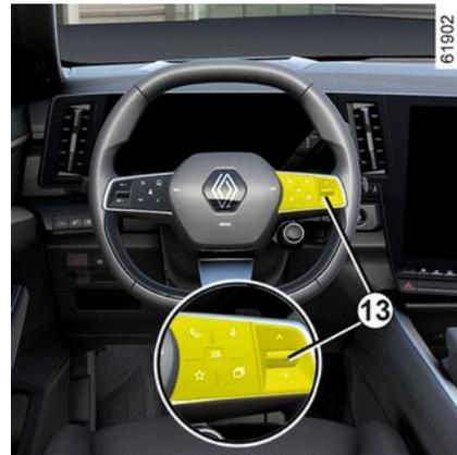
Suivant véhicule, naviguez à l'aide de la commande 13 pour sélectionner dif-
