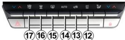
Appuyez sur la touche **15**, le témoin intégré s'allume. Cette fonction permet un désembuage rapide de la lunette arrière et des rétroviseurs dégivrants (pour les véhicules qui en sont équipés).
