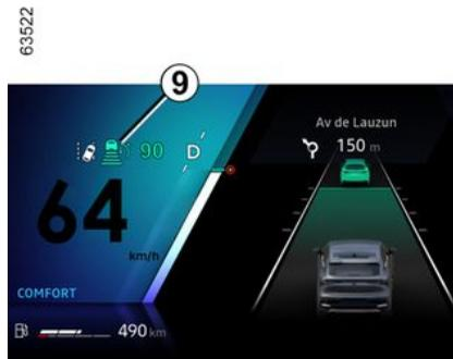
Le radar permet de détecter les véhicules qui vous précèdent. Le système ne peut pas fonctionner correctement si la zone du radar est occultée ou si son signal est perturbé.
