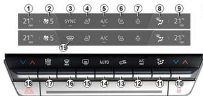
1. Indicateur température chauffage conducteur.
