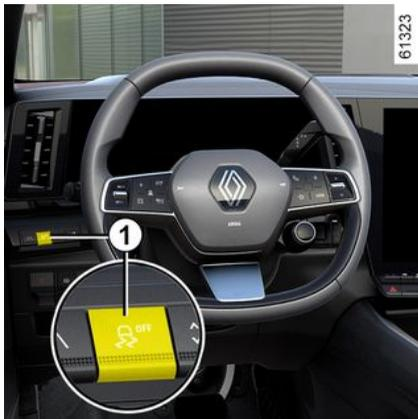
Dans certaines situations (conduite sur sol très mou : neige, boue... ou conduite avec des roues chainées), le système peut réduire la puissance moteur pour limiter le patinage. Activez la fonction par appui sur le contacteur **1**. Si cet effet n'est pas souhaité, il est possible de désactiver la fonction par appui sur le contacteur **1**. Dans ce
