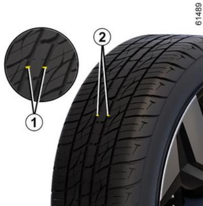
Lorsque le relief des sculptures a été érodé jusqu'au niveau des bossages-témoins, **ceux-ci deviennent visibles 2** : il est alors nécessaire de **remplacer vos pneumatiques car la pro-**
