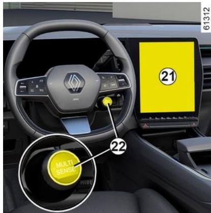
Depuis le menu MULTI-SENSE accessible depuis l'écran multimédia **21** ou en appuyant sur le contacteur **22**, vous pouvez activer le mode ECO qui agit sur le confort thermique et permet de réduire la consommation du véhicule.
