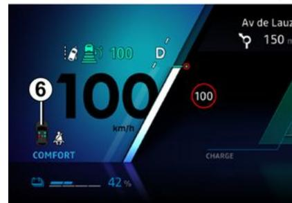
Portes fermées, le visuel **6** s'affiche au tableau de bord à la mise sous contact du véhicule pendant 60 secondes environ. Il indique au conducteur l'état de bouclage de chacune des ceintures avant à chaque :
