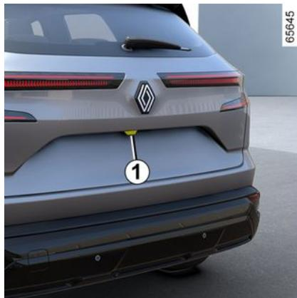
Au passage de la marche arrière, la caméra **1** située sur le hayon transmet une vue de l'environnement arrière du véhicule sur l'écran multimédia **2** accompagnée d'un à trois gabarits **3**, **4** et **5** (fixe, mobile et remorque).
