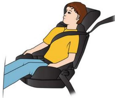
Dès 15 kg ou 4 ans l'enfant peut voyager sur un rehausseur qui permet d'adapter la ceinture de sécurité à sa morphologie. L'assise du rehausseur doit être munie de guides positionnant la ceinture sur les cuisses de l'enfant et non sur le ventre. Un dossier réglable en hauteur et équipé d'un guide sangle est conseillé pour placer la ceinture au milieu de l'épaule. Elle ne doit jamais être sur le cou ou sur le bras.
