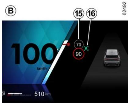
À l'aide de la caméra, de la fonction « Détection de panneaux de signalisation routière » ➔ 232 et de la cartographie souscrite avec l'abonnement, le système anticipe l'adaptation automatique de la vitesse du véhicule jusqu'au franchissement d'un prochain panneau de limitation de vitesse identifié **15**.
