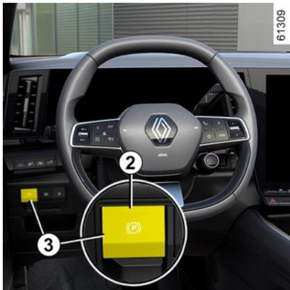
Pour actionner manuellement le frein de parking assisté (arrêt à un feu rouge, arrêt moteur allumé...) : tirez et relâchez le contacteur **3**. Le desserrage est automatique dès le redémarrage du véhicule.
