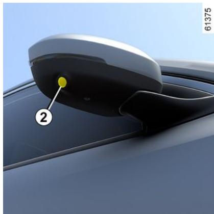
La vue de la caméra 2, implantée dans le rétroviseur extérieur, transmet
