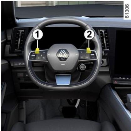
Les palettes **1** et **2** permettent de changer de niveau de freinage régénératif lorsque le levier est en position D.
