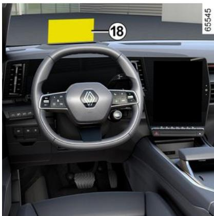
L'afficheur reprend des informations de conduite et de navigation du tableau de bord et de l'écran multimédia. Les informations sont projetées sur le pare-brise.
