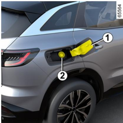
Utilisez **impérativement** de l'essence sans plomb. L'indice d'octane (RON) doit être conforme aux indications portées sur l'étiquette située sur le portillon **1** → 401.
