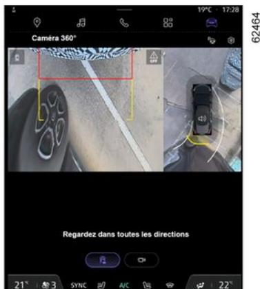
En cas de détection d'un obstacle à proximité de l'avant ou de l'arrière du véhicule, la fonction « Zoom auto » fait basculer l'affichage en
