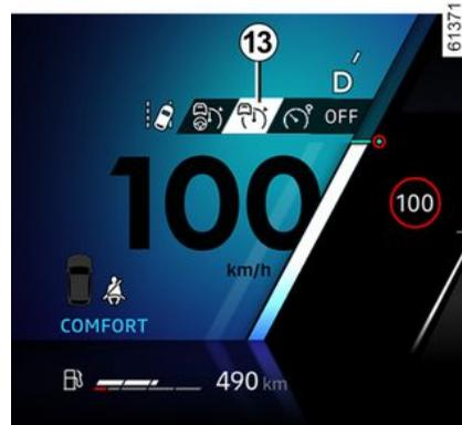
Appuyez autant de fois que nécessaire sur le contacteur 3 pour sélectionner en 13 le régulateur de vitesse adaptatif. Le témoin 9 s'allume en gris. Le message « Régulateur adaptatif prêt: SET pour activer » appa-
