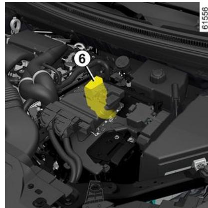
Le circuit électrique « 400 volts » est reconnaissable aux câblages de couleur orange **6** et aux éléments repérés par le symbole
