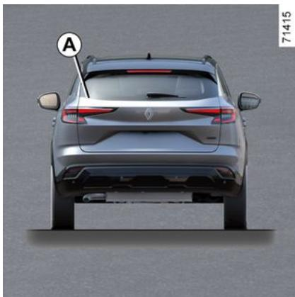
**7** Le QR Code figurant sur l'étiquette **A** permet aux professionnels de secours au moyen d'une tablette ou d'un smartphone, d'accéder immédiatement aux informations techniques utiles pour une intervention sur le véhicule en cas d'accident. Veillez à ce que l'étiquette **A** soit toujours visible et présente sur le pare-brise ainsi que sur la lunette arrière.
