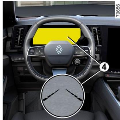
Fonction activée, le témoin
