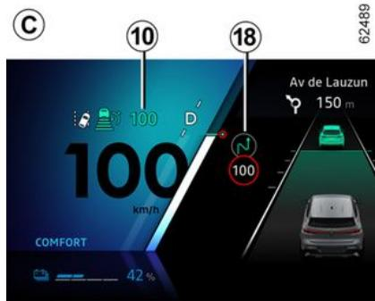
À l'aide de la caméra, de la fonction « Détection de panneaux de signalisation routière » → 239, et de la cartographie souscrite avec l'abonnement, le système peut anticiper et gérer l'adaptation automatique de la vitesse de régulation de la vitesse de régulation **10**, lorsque le véhicule aborde un rond-point ou un virage.
