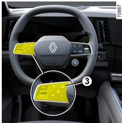
La fonction régulateur de vitesse adaptatif Stop and Go est interrompue lorsque vous agissez sur le contacteur **3**.
