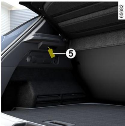
Déclippez (à l'aide d'un outil type tournevis plat) l'éclaireur de coffre **5** en pressant sur la languette côté gauche de l'éclaireur.
