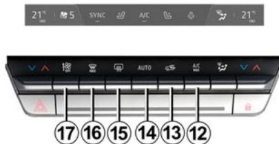
Appuyez sur la touche **15**, le témoin intégré s'allume. Cette fonction permet un désembuage rapide de la lunette arrière et des rétroviseurs dégivrants (pour les véhicules qui en sont équipés).
