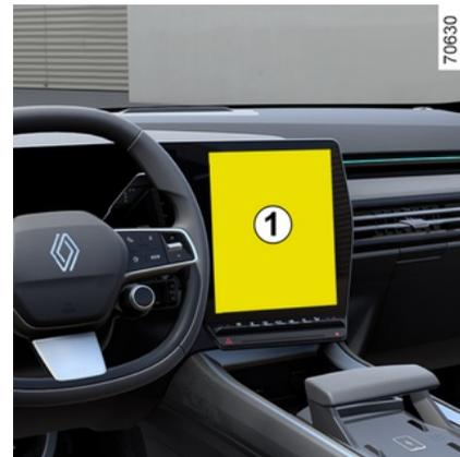
Véhicule à l'arrêt, moteur allumé, depuis le Monde « Véhicule » **2** de l'écran multimédia **1**, appuyez sur le menu « Electrique » **3** puis sur l'onglet « Programmes » pour accéder aux paramètres de réglages.
