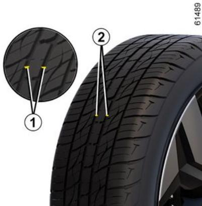
Lorsque le relief des sculptures a été érodé jusqu'au niveau des bossages-témoins, **ceux-ci deviennent visibles 2** : il est alors nécessaire de remplacer vos pneumatiques car la
