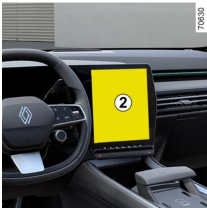
Depuis l'écran multimédia, lorsque la marche arrière est engagée, appuyez sur le bouton « Réglages » afin d'ajouter ou de supprimer les gabarits et régler les paramètres de l'image de la caméra (luminosité, contraste...).
