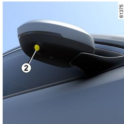
La vue de la caméra 2, implantée dans le rétroviseur extérieur, transmet une vue latérale sur l'écran multimédia 5.
