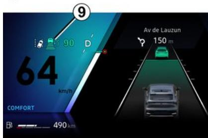
Le radar permet de détecter les véhicules qui vous précèdent. Le système ne peut pas fonctionner correctement si la zone du radar est occultée ou si son signal est perturbé.
