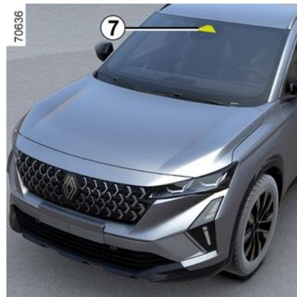
Suivant véhicule, les feux de route adaptatifs sont divisés en plusieurs segments verticaux indépendants. Cette fonction utilise une caméra **7** située derrière le rétroviseur intérieur pour détecter les véhicules suivis et les véhicules venant en sens inverse.
