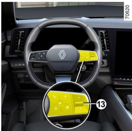
Suivant véhicule, naviguez à l'aide de la commande **13** pour sélectionner différents widgets sur le tableau de bord :
