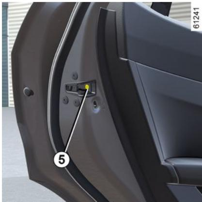
Porte ouverte, faites pivoter la vis **5** (à l'aide de l'embout de la clé) et fermez la porte.
