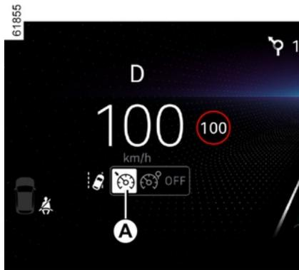
Appuyez autant de fois que nécessaire sur le contacteur **1** pour sélectionner en **A** le régulateur de vitesse.
