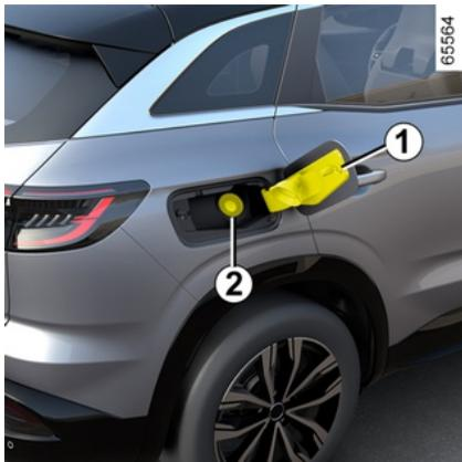
Utilisez **impérativement** de l'essence sans plomb. L'indice d'octane (RON) doit être conforme aux indications portées sur l'étiquette située sur le portillon **1** → 412.
