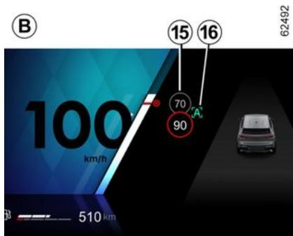
À l'aide de la caméra, de la fonction « Détection de panneaux de signalisation routière » ➔ 239 et de la cartographie souscrite avec l'abonnement, le système anticipe l'adaptation automatique de la vitesse du véhicule jusqu'au franchissement d'un prochain panneau de limitation de vitesse identifié 15.
