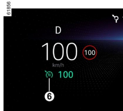
L'extinction du témoin 6 au tableau de bord confirme l'arrêt de la fonction.
