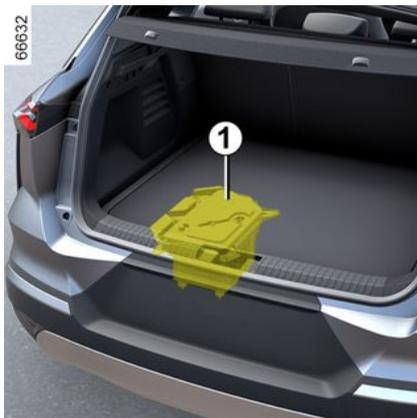
La batterie secondaire « 12 volts » est située dans le coffre : elle fournit l'énergie nécessaire à l'ouverture/fermeture du véhicule et au fonctionnement des équipements.
