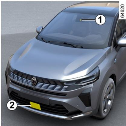
À partir des informations provenant de la caméra **1** et du radar **2**, le système détermine la distance qui sépare votre véhicule :
