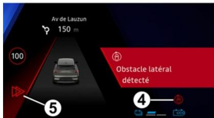
le message «Risque de collision» s'affiche au tableau de bord accompagné du témoin **4** en rouge, de la ligne du côté de l'intervention et d'un signal sonore. L'affichage **5** apparaît au tableau de bord du côté de l'intervention ;
