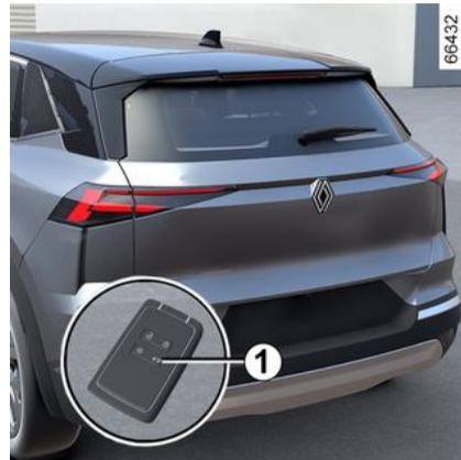
Moteur non allumé, faites un appui long sur le contacteur **1** de la carte, à proximité du coffre.
