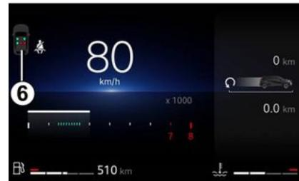
Portes fermées, le visuel **6** s'affiche au tableau de bord à la mise sous contact du véhicule pendant 60 secondes environ. Il indique au conducteur l'état de bouclage de chacune des ceintures avant à chaque :
