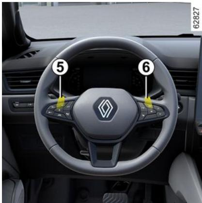
Les palettes **5** et **6** permettent de changer de rapport lorsque la position engagée est la position **D**.
