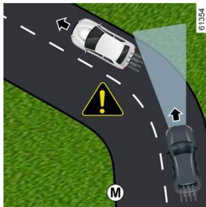
À l'entrée d'un virage et en courbe, le radar et/ou la caméra peuvent ne plus détecter temporairement le véhicule précédent (exemple **M**).
