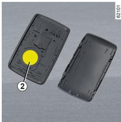
Lorsque le message « Pile carte faible » apparaît au tableau de bord, remplacez la pile de la carte :
