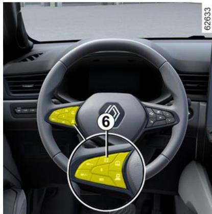
Pour adapter la consigne du limiteur de vitesse, du régulateur ou du régulateur de vitesse adaptatif aux limitations de vitesse détectées : faites un appui court le contacteur 6 pour adapter la vitesse du véhicule à la limitation indiquée sur le dernier panneau de signalisation détecté.
