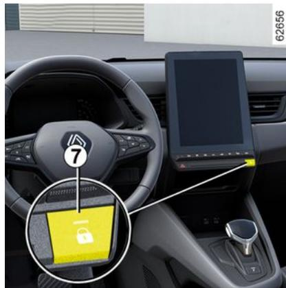
Le contacteur **7** commande simultanément les portes, le coffre et la trappe à carburant.
