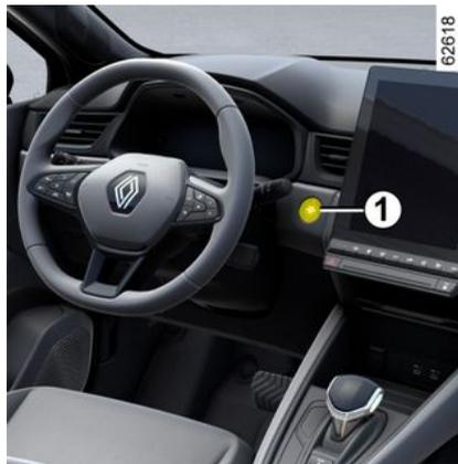
Appuyez sur le contacteur **1** sans appuyer sur les pédales pour la mise sous contact du véhicule. Appuyez sur la pédale de frein puis appuyez sur le contacteur **4** : le témoin **3** du
