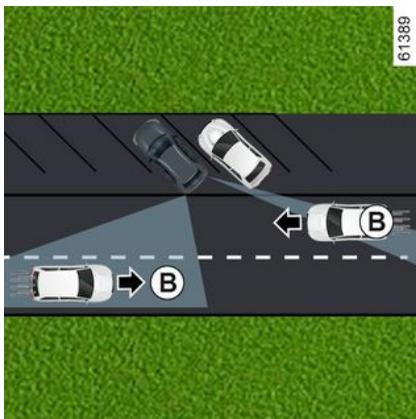
À partir des informations provenant des radars installés de chaque côté du pare-chocs arrière (zone **A**), la fonction avertit le conducteur lorsqu'un autre véhicule se trouve dans le périmètre de détection **B**.
