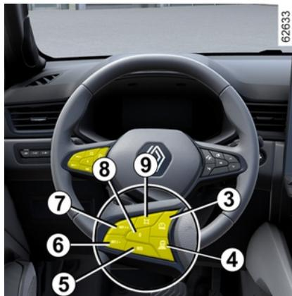
La fonction « Régulateur de vitesse adaptatif » est interrompue lorsque vous appuyez sur le contacteur **3** pour désélectionner le régulateur de vitesses adaptatif.
