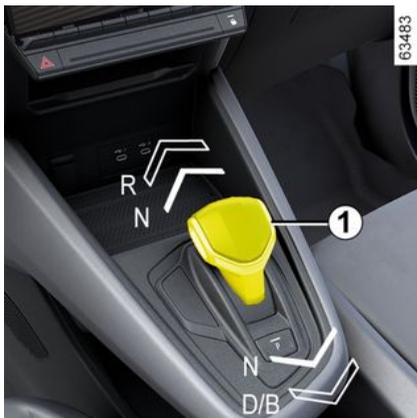
Basculez le levier de sélection **1** d'un cran ou de deux crans vers l'avant ou vers l'arrière pour engager la position désirée (**R**, **N**, **D** ou, suivant véhicule, **B**) puis relâchez le levier, il revient dans sa position stable.
