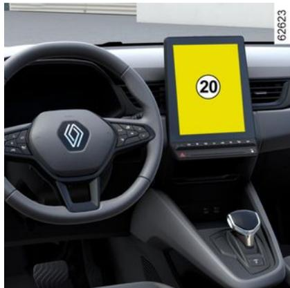
Depuis le menu MULTI-SENSE accessible depuis l'écran multimédia **20** ou en appuyant sur le contacteur **19**, vous pouvez activer le mode ECO qui agit sur le confort thermique et permet de réduire la consommation du véhicule.
