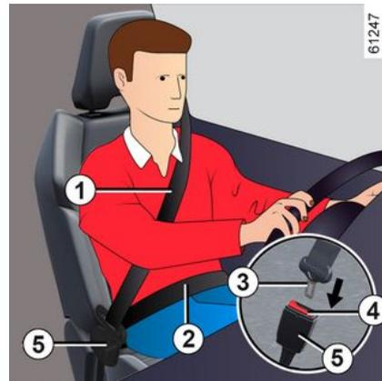
Pour un ajustement et un positionnement corrects des ceintures de sécurité à toutes les places :
