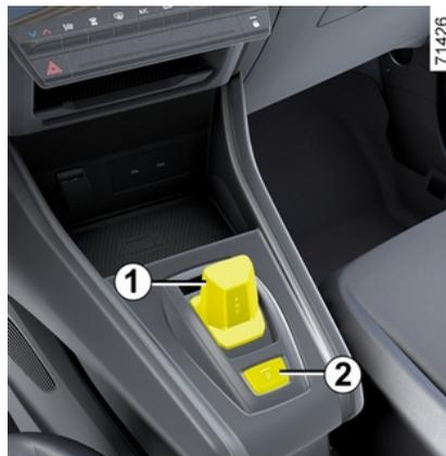
Basculez le levier de sélection **1** d'un cran ou de deux crans vers l'avant ou vers l'arrière pour engager la position désirée (**R, N, D**) puis relâchez
