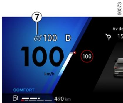
La fonction limiteur de vitesse est interrompue : lorsque vous agissez sur le contacteur **1** pour désélectionner le limiteur. Dans ce cas il n'y a plus de vitesse mémorisée
