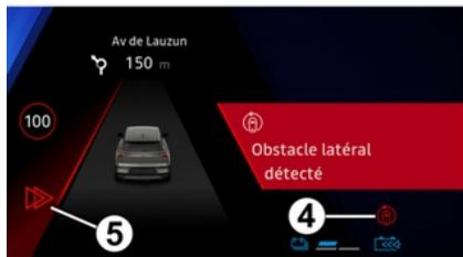
ne), lorsqu'il y a un risque de collision avec un véhicule qui se trouve dans la zone d'angle mort **D** et se déplace dans la même direction que votre véhicule ou avec un véhicule qui s'approche rapidement par l'arrière sur une voie adjacente dans le périmètre de détection **E**, le système :
