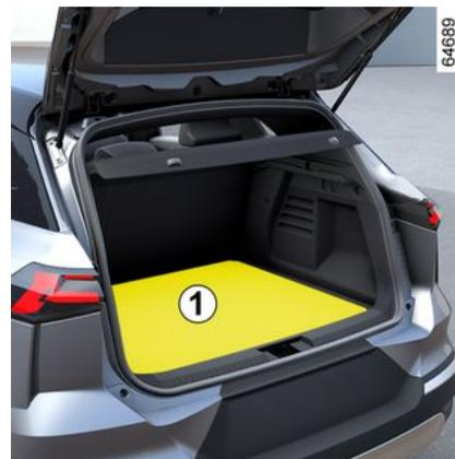
Il permet, en basculant le dossier de la banquette arrière, d'obtenir un plancher plat et de compartimenter le coffre en deux espaces distincts.
