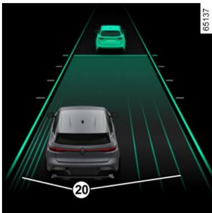
Pour activer l'ajustement de la position dans la voie, la fonction « Centrage voie » doit être en régulation
