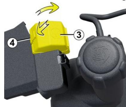
**Nota :** ouvrez le couvercle 3 du bornier 1 (+) en appuyant sur le bouton 4 suivant flèche.
