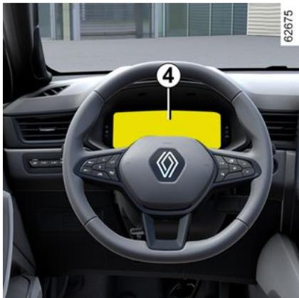
Le tableau reprend les messages d'alerte au tableau de bord **4** lorsque le système détecte une éventuelle anomalie de gonflage.
