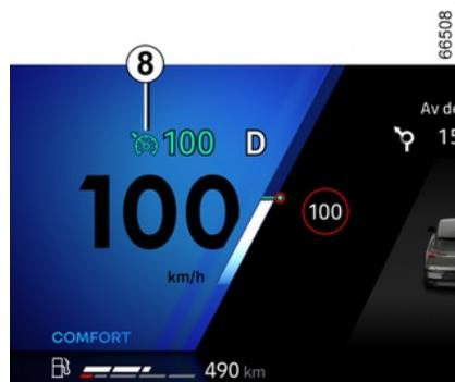
Appuyez autant de fois que nécessaire sur le contacteur **7** pour sélectionner le régulateur de vitesse **7**.
