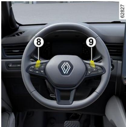
Suivant véhicule, les palettes **8** et **9** permettent de changer de rapport lorsque le levier est en position **D**.
