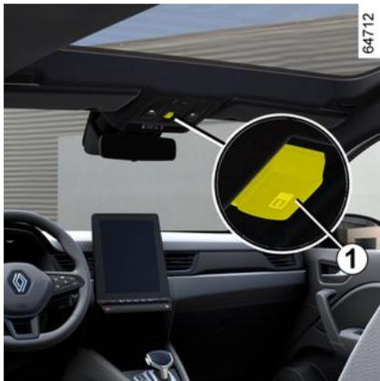
Pour basculer en mode opaque ou mode transparent **la totalité du toit**, faites un appui long sur le contacteur **1**.
