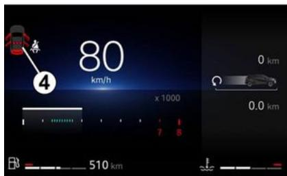
À l'arrêt, contact mis, le visuel 4 indique au tableau de bord le ou les ouvrants (porte, coffre) ouverts ou mal fermés.
