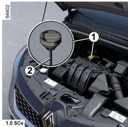
Le véhicule doit être sur sol horizontal, moteur arrêté et froid (par exemple : avant le premier démarrage de la journée).
