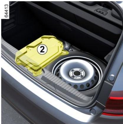
La batterie secondaire « 12 volts » **2** est située dans le coffre du véhicule E-tech full hybrid : elle fournit l'énergie nécessaire à l'ouverture/fermeture du véhicule et au fonctionnement des équipements.
