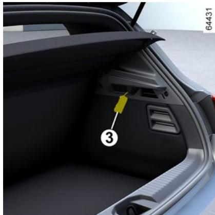
Déclipsez (à l'aide d'un outil type tournevis plat) l'éclaireur **3** en pressant sur la languette côté gauche de l'éclaireur.
