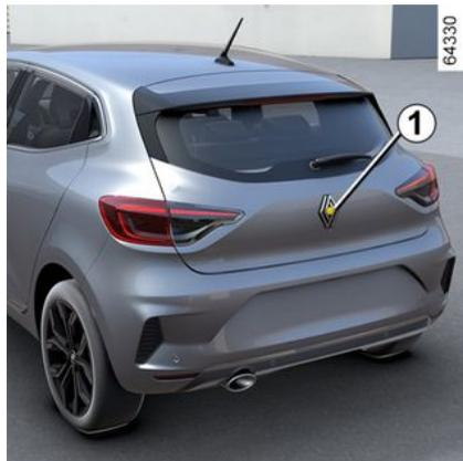
Au passage de la marche arrière, la caméra **1** située sur le hayon transmet une vue de l'environnement arrière du véhicule sur l'écran multimédia **2** accompagné d'un ou de deux gabarits **3** et **4** (fixe et mobile).
