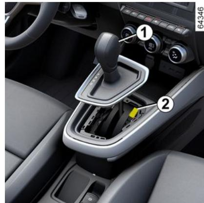
À la mise en route, dans le cas où le levier est bloqué sur P alors que vous appuyez sur la pédale de frein, il y a possibilité de libérer manuellement le levier pour débloquer les roues motrices.
