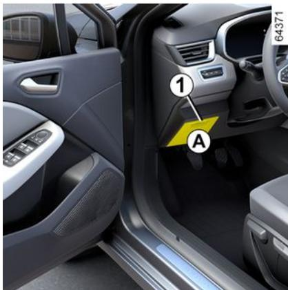
En cas de non-fonctionnement d'un appareil électrique, vérifiez l'état des fusibles.
