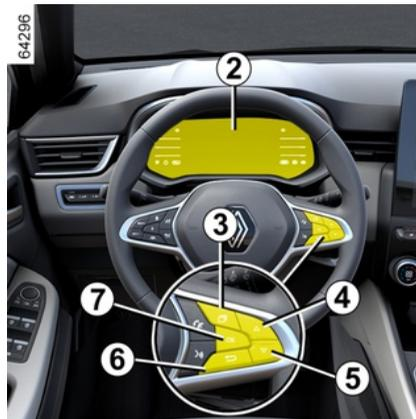
– Véhicule à l'arrêt, appuyez sur le contacteur 3 autant de fois que nécessaire pour vous positionner sur le Monde « Réglages » ;
