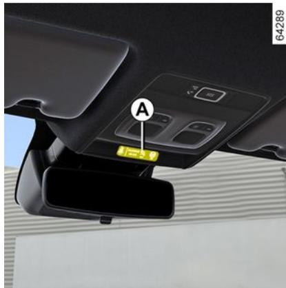
**Nota** : suivant véhicule, un objet posé sur l'assise passager peut, dans certains cas, déclencher le témoin d'alerte.
