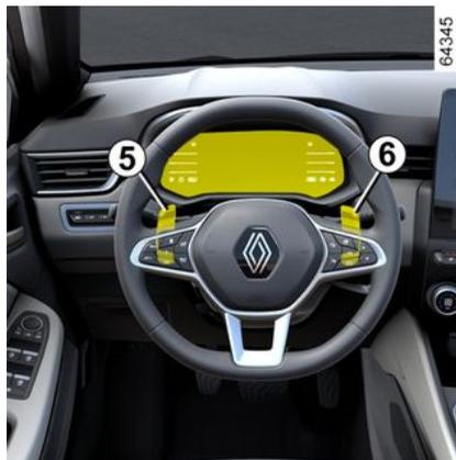
Suivant véhicule, les palettes **5** et **6** permettent de changer de rapport lorsque le levier est en position D.
