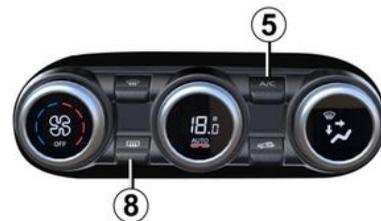
Appuyez sur la touche **8**, le témoin intégré s'allume. Cette fonction permet un désembuage rapide de la lunette arrière et des rétroviseurs dégivrants (pour les véhicules qui en sont équipés).
