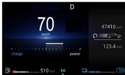
Le témoin **2 EV** affiché au tableau de bord, vous informe que le système E-tech full hybrid utilise uniquement le groupe électrique pour le déplacement du véhicule.
