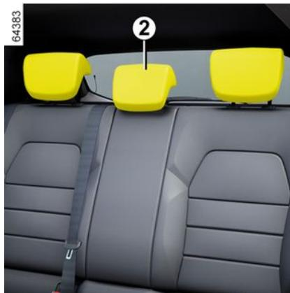
Introduisez les tiges dans les fourreaux, enfoncez l'appui-tête jusqu'au blocage pour l'utiliser en position haute.
