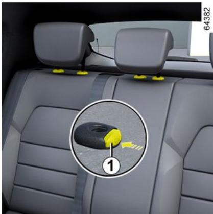
Montez l'appui-tête au maximum jusqu'au blocage.
