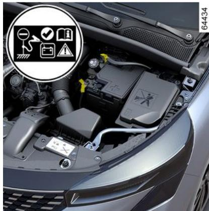
**i** N'utilisez pas votre véhicule E-tech full hybrid pour dépanner la batterie « 12 volts » d'un autre véhicule. La puissance électrique de la batterie secondaire « 12 volts » d'un véhicule E-tech full hybrid est insuffisante pour cette opération.
