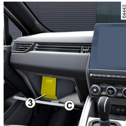
Fusibles situés dans l'habitacle derrière une trappe dans la boîte à gants C
