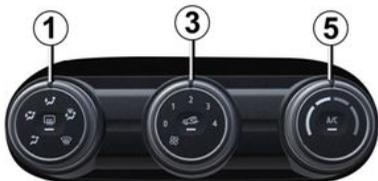
Manœuvrez la commande **3** pour ajuster la quantité d'air pulsé. Si vous désirez arrêter l'arrivée d'air, placez la commande **3** sur « 0 » (commande **A**) ou « OFF » (commande **B**).
