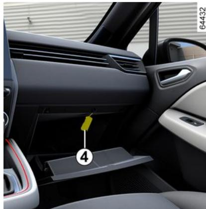
Déclipsez (à l'aide d'un outil type tournevis plat) l'éclaireur **4** en pressant sur la languette côté gauche de l'éclaireur.
