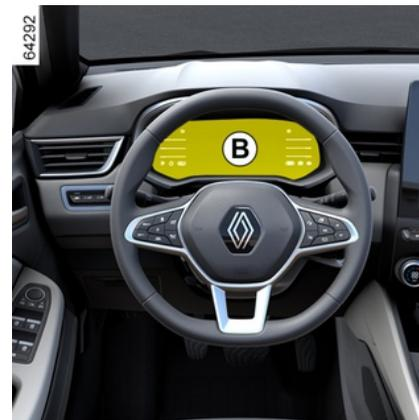
Le tableau reprend les messages d'alerte au tableau de bord **B** lorsque le système détecte une éventuelle anomalie de gonflage.
