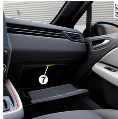
Suivant véhicule, l'éclaireur **7** s'allume à l'ouverture du portillon.
