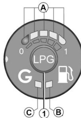
Elle permet de passer manuellement d'un mode de carburant à un autre.
