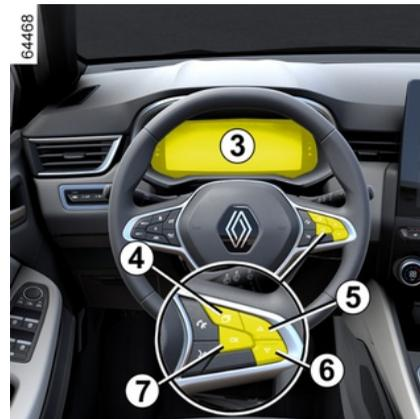
– Véhicule à l'arrêt, appuyez sur le contacteur **4** autant de fois que nécessaire pour vous positionner sur l'onglet « VEHICULE » ;
