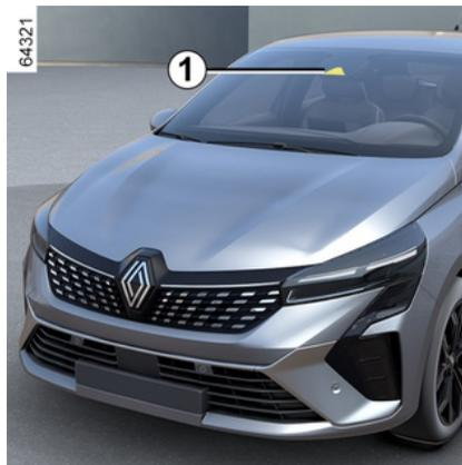
A partir des informations provenant de la caméra 1, la fonction se déclenche par une action corrective sur le système de direction du véhicule en cas de franchissement d'une ligne ou à l'approche d'un bord de route (terre-plein, barrière, trottoir, talus...) sans avoir activé les feux indicateurs de direction.
