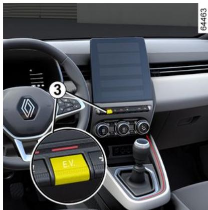
Lorsque le système E-tech full hybrid utilise le moteur thermique et/ou le moteur électrique pour le déplacement du véhicule, il est possible de basculer manuellement en mode tout électrique.
