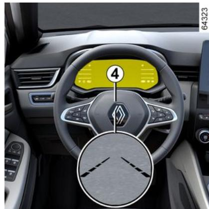
Fonction activée, suivant véhicule, le témoin
