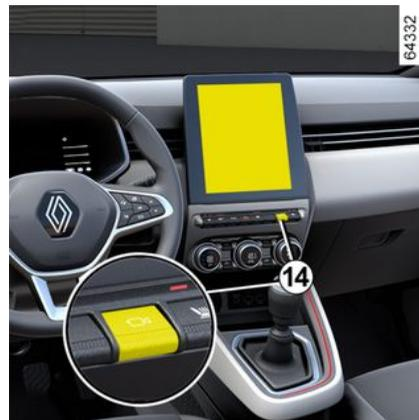
Contact mis, appuyez sur le contacteur **14** ou déplacez le levier de sélection en position P (pour les véhicules à boîte de vitesses automatique) ou en marche arrière (pour les véhicules à boîte de vitesses manuelle) pour utiliser la fonction.
