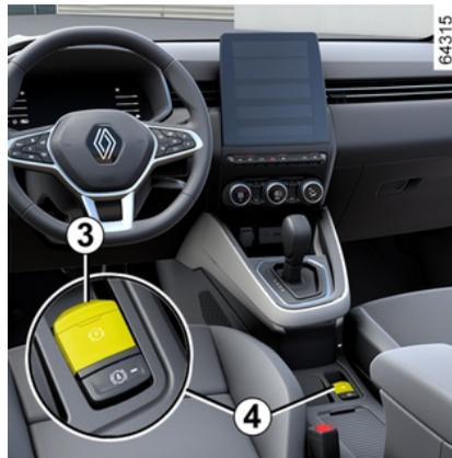
Pour actionner manuellement le frein de parking assisté (arrêt à un feu rouge, arrêt moteur allumé...): tirez et relâchez le contacteur **4**.
