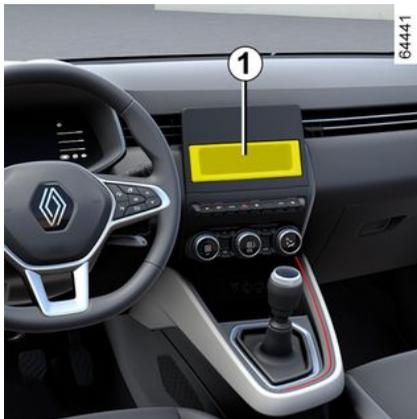
Déclipez l'obturateur. Les connexions : antenne, alimentation + et -, fils de haut-parleurs se trouvent derrière.
