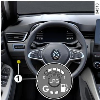
Ces véhicules fonctionnent sur le principe de bicarburant, en faisant recours à deux types de carburant : le GPL et l'essence.
