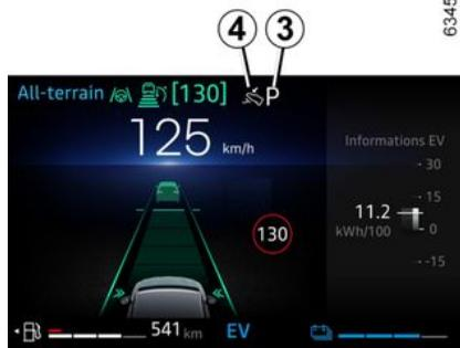
L'afficheur 3 au tableau de bord vous informe de la position engagée du levier de sélection 1.
