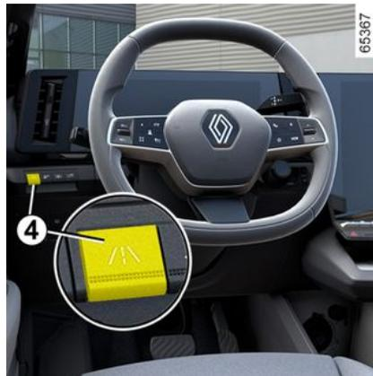
Avant d'activer la fonction, depuis le Monde « Véhicule » de l'écran multimédia 2, appuyez sur le menu « Aides à la conduite » puis sur le menu « Maintien dans la voie », sélectionnez « Alerte sortie de voie ».
