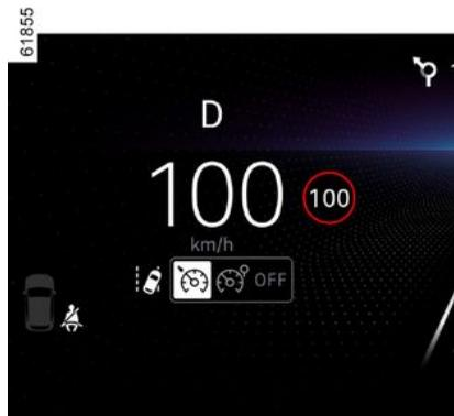
Appuyez autant de fois que nécessaire sur le contacteur 1 pour sélectionner le régulateur de vitesse.
