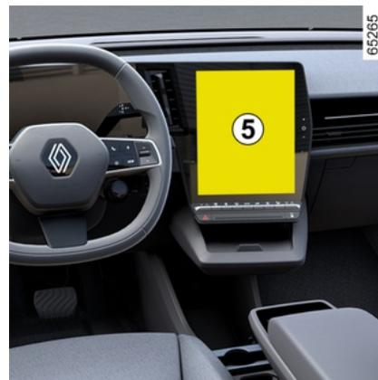
À partir de l'écran multimédia, lorsque le système « Caméra 360° » est affiché, vous pouvez changer les vues (exemple : remplacer la vue arrière par la vue arrière panoramique).
