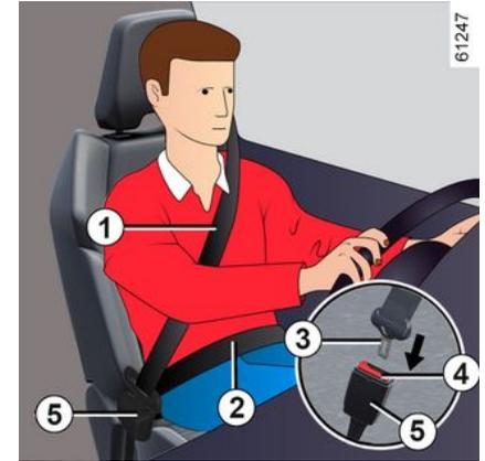
Pour un ajustement et un positionnement corrects des ceintures de sécurité à toutes les places :
