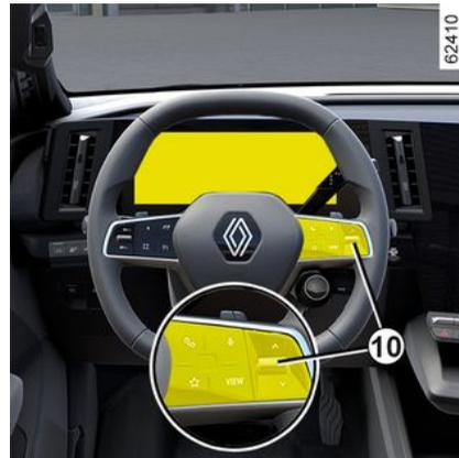
**Zone d'informations 7**, naviguez à l'aide de la commande 10 pour sélectionner différents widgets sur le tableau de bord A :
