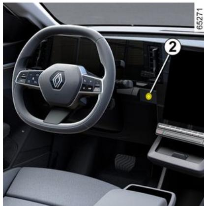
Si le smartphone n'est plus dans l'habitacle lorsque vous demandez l'arrêt moteur, un message s'affiche au tableau de bord : appuyez plus de deux secondes sur le bouton de démarrage/arrêt du moteur **2**.
