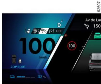
Appuyez autant de fois que nécessaire sur le contacteur 3 pour sélectionner le régulateur de vitesse adaptatif. Le témoin 10 s'allume en gris. Le message « Régulateur adaptatif prêt: SET pour activer » apparaît au tableau de
