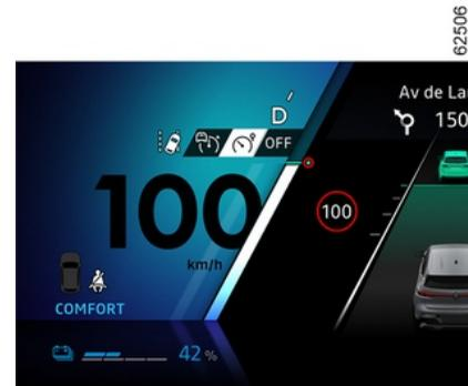
Appuyez autant de fois que nécessaire sur le contacteur 1 pour sélectionner le limiteur de vitesse.
