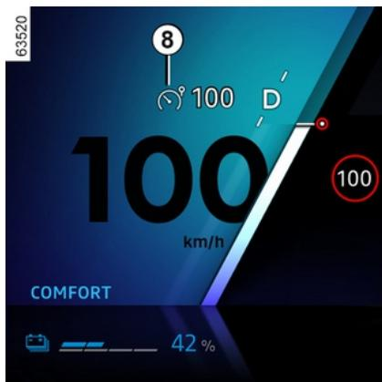
Le témoin **8** s'allume en gris. Le message « Limiteur prêt : SET pour activer » apparaît au tableau de bord accompagné de tirets pour indiquer que la fonction limiteur de vitesse est en service et en attente de l'enregistrement d'une vitesse de limitation.
