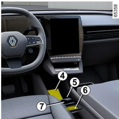
Un séparateur **7** permet de moduler le rangement de console central (différentes positions possibles selon la position du séparateur dans les rainures **5** de fixation choisies).
