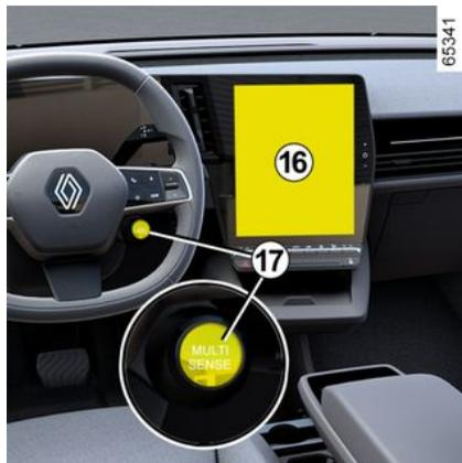
Depuis le menu MULTI-SENSE accessible depuis l'écran multimédia **16** ou en appuyant sur le contacteur **17**, vous pouvez activer le mode ECO qui agit sur le confort thermique et permet de réduire la consommation du véhicule.
