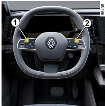
Suivant véhicule, les palettes **1** et **2** permettent de changer le niveau de freinage régénératif lorsque le levier de vitesses est en position **D**.
