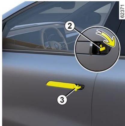
Basculez le cache-verrou **3** en appuyant sur la partie gauche et introduisez la clé **2** dans la serrure et verrouillez ou déverrouillez la porte conducteur.
