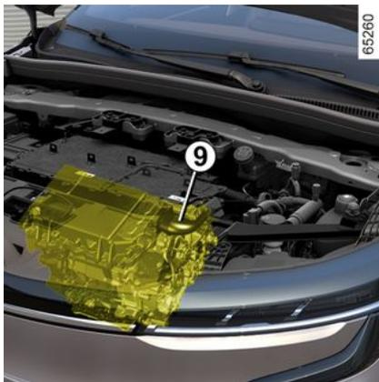
Le circuit électrique « 400 volts » est reconnaissable aux câblages de couleur orange **9** et aux éléments repérés
