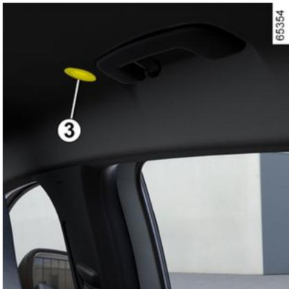
**i** Le déverrouillage et l'ouverture des portes entraînent l'éclairage temporaire des plafonniers et des éclairateurs.
