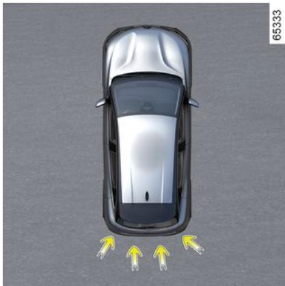
En complément de la fonction « Aides au parking » ➔ 297 et à partir des informations provenant des quatre capteurs centraux situés à l'arrière du véhicule, le système détecte les obstacles fixes se situant derrière votre véhicule. Si le risque de collision est important, le système freine automatiquement le véhicule.
