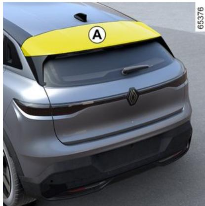
Il est **interdit** de fixer des objets et/ou accessoires (porte-vélos...) en appui sur le becquet **A**.
