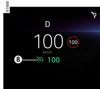
Le témoin 8 s'allume en gris. Le message « Régulateur prêt: SET pour activer » apparaît au tableau de bord accompagné de tirets pour indiquer que la fonction régulateur de vitesse est en service et en attente de l'enregistrement d'une vitesse de régulation.
