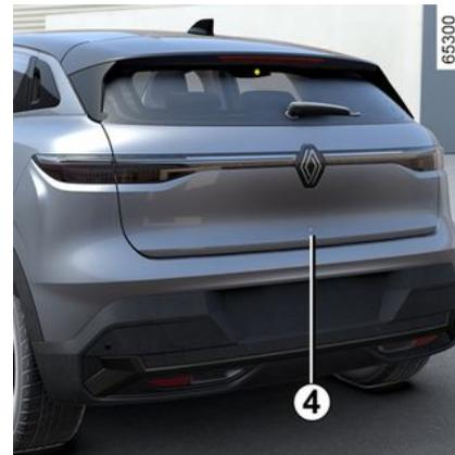
Carte dans la zone **1** et véhicule verrouillé, un appui sur le bouton **4** déverrouille tout le véhicule.
