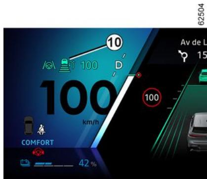
Le radar permet de détecter les véhicules qui vous précèdent. Le système ne peut pas fonctionner correctement si la zone du radar est occultée ou si son signal est perturbé.
