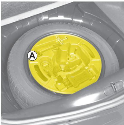
Le bloc outils **A** est situé dans le coffre, sur la roue de secours.
