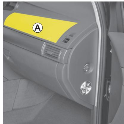
Le système d'airbag utilise un principe pyrotechnique, ce qui explique qu'à son déploiement, il produit une chaleur, libère de la fumée (ce qui n'est pas le signe d'un départ d'incendie) et génère un bruit de détonation. Le déploiement de l'airbag, qui doit être immédiat, peut provoquer des blessures à la surface de la peau ou autres désagréments.
