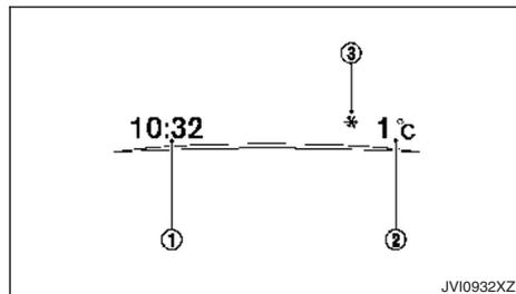
La montre (1) et la température d'air extérieur (2) s'affichent sur la partie supérieure de l'écran d'informations du véhicule.
