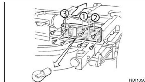
Bloc optique arrière (clignotant, stop et feu de recul) (modèles sans benne)
