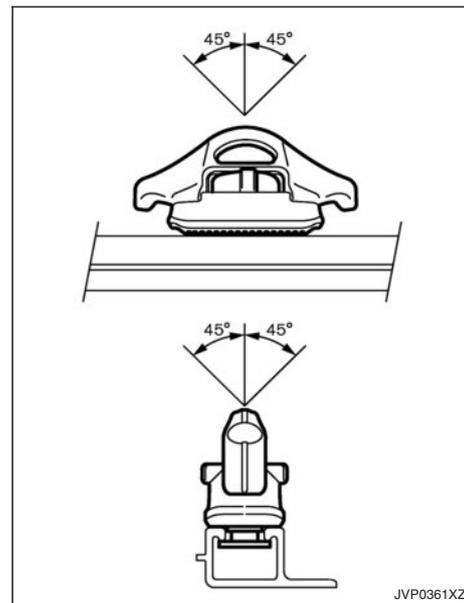
4. Il ne doit pas y avoir d'écartement entre la partie inférieure du taquet et la partie supérieure de la glissière. Serrez fermement le boulon central.
