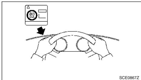
1. Retirez l'autocollant de limitation de vitesse du compresseur\*, puis placez-le à un emplacement visible par le conducteur pendant la conduite.
