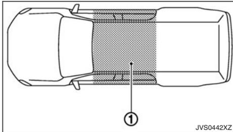
La télécommande permet le démarrage du moteur seulement si elle se trouve dans le périmètre de fonctionnement spécifié ①, comme indiqué sur l'illustration.
