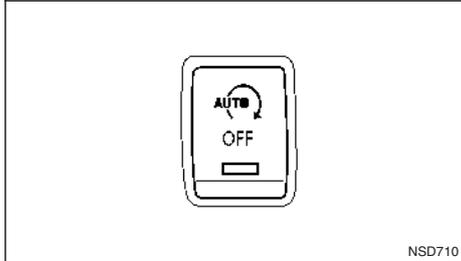
Le système peut être provisoirement désactivé en appuyant sur la commande de désactivation du système Stop/Start. Le fait d'appuyer sur la commande à nouveau ou redémarrer le moteur à l'aide du contact d'allumage permet de réactiver le système Stop/Start.
