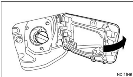
Pour ouvrir la trappe du réservoir de liquide AdBlue®, appuyez légèrement sur la trappe de réservoir de liquide AdBlue® et relâchez-la.
