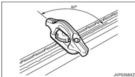
2. Insérez le taquet dans la glissière de manière perpendiculaire comme indiqué sur l'illustration. Faites ensuite pivoter le taquet dans le sens des aiguilles d'une montre de 90° puis faites-le coulisser jusqu'à l'emplacement souhaité.
