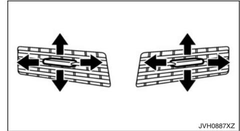
Il est possible de régler l'orientation du débit d'air des bouches d'aération en déplaçant la commande centrale (vers le haut/bas, vers la gauche/droite) jusqu'à atteindre la position souhaitée.
