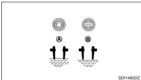
Vérifiez le niveau de liquide de chaque élément. Le niveau du liquide de batterie doit être situé entre le repère de NIVEAU SUPERIEUR ① et le repère de NIVEAU INFERIEUR ②.
