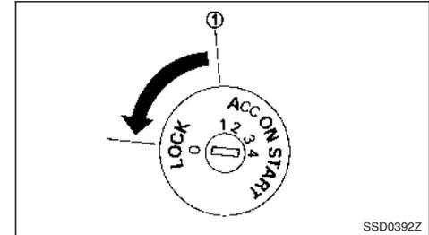
Bien qu'elle ne soit pas indiquée sur le contact d'allumage, il existe une position "arrêt" ① entre les positions <LOCK> et <ACC>.
