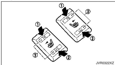
Les sièges avant peuvent être chauffés par des modules de chauffage intégrés. Les commandes situées sur la console centrale peuvent être actionnées indépendamment les unes des autres.
