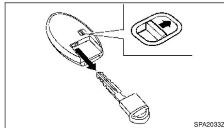
Pour retirer la clé mécanique, relâchez le bouton de verrouillage situé à l'arrière de la télécommande.
