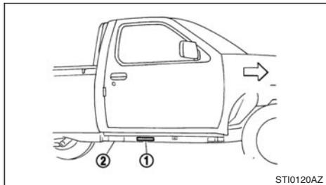
Le numéro d'identification du véhicule (numéro de châssis) ① est gravé sur le châssis ② comme indiqué.
