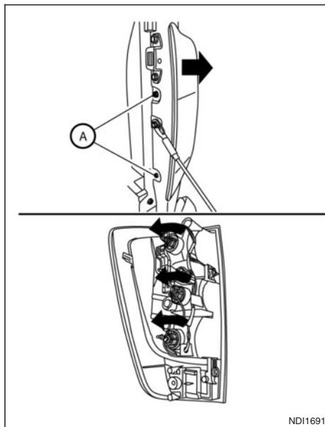
Bloc optique arrière (clignotant, stop, antibrouillard arrière (selon modèles) et recul) (modèles avec benne)
