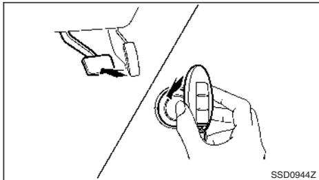
Si la pile de la télécommande est déchargée, ou si les conditions environnementales perturbent le fonctionnement de la télécommande, démarrez le moteur en vous reportant à la procédure suivante :
