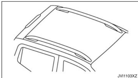
Ne posez aucune charge directement sur les longerons latéraux de toit. Des barres transversales doivent être installées avant de poser une charge/un chargement/des bagages sur le toit du véhicule.
