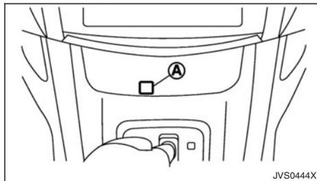
Si la batterie est déchargée, le levier de changement de vitesses ne peut pas être déplacé depuis la position P (stationnement), même si la pédale de frein est enfoncée.
