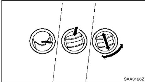
Réglez l'orientation du débit d'air des bouches d'aération en les ouvrant, les fermant ou en les faisant pivoter.
