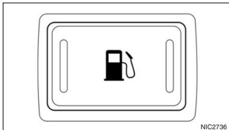
Pour ouvrir la trappe de réservoir à carburant, appuyez sur la commande d'ouverture de trappe de réservoir à carburant située sur la partie inférieure du tableau de bord.
