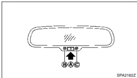
Le rétroviseur intérieur est conçu de façon à changer automatiquement le reflet en fonction de l'intensité des phares du véhicule qui suit.
