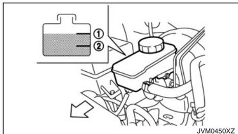
Vérifiez le niveau de liquide dans le réservoir. Si le niveau de liquide est inférieur au repère MIN ②, le témoin d'avertissement de frein s'allume. Ajoutez du liquide jusqu'au repère MAX ①.
