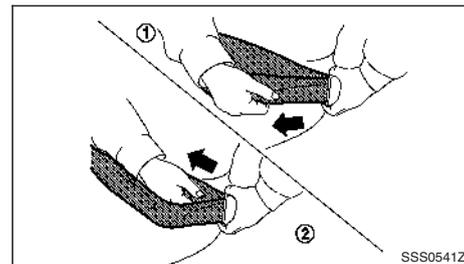
2. Réglez la longueur de la ceinture de sécurité. Pour la raccourcir, tenez la languette et tirez la partie supérieure de la ceinture comme indiqué sur l'illustration ①. Pour l'allonger, tenez la languette et tirez la partie inférieure de la ceinture comme indiqué sur l'illustration ②.
