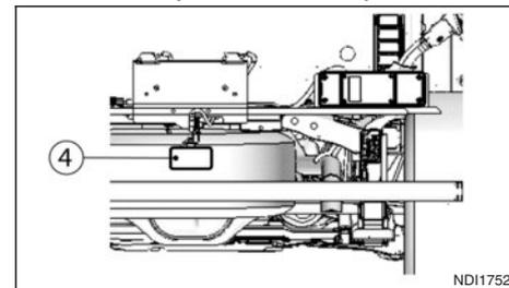
Feu antibrouillard arrière (selon modèles pour les modèles sans benne)
