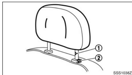
1. Alignez les tiges de l'appuie-tête avec les orifices situés sur le siège. Assurez-vous que l'appuie-tête est monté dans le sens correct. La tige comportant l'encoche de réglage ① doit être insérée dans l'orifice avec le bouton de verrouillage ②.
