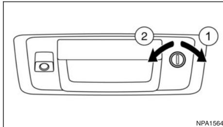
Pour verrouiller le hayon, insérez la clé dans le cylindre de clé du hayon et tournez la clé dans le sens des aiguilles d'une montre ①.
