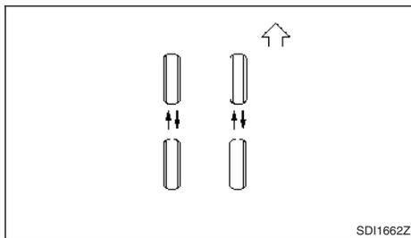
RENAULT recommande de permuter les roues tous les 5 000 km (3 000 miles) pour les modèles à quatre roues motrices (4x4) ou tous les 10 000 km (6 000 miles) pour les modèles à deux roues motrices (4x2). Cependant, la fréquence de permutation peut varier en fonction de vos habitudes de conduite et de l'état de la route. (Reportez-vous à "Pneu à plat" dans le chapitre "6. En cas d'urgence" pour le remplacement des pneus.)
