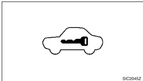
Le témoin de sécurité, situé sur le tableau de bord, s'active dès que le contact d'allumage est sur la position LOCK, arrêt ou ACC. Ceci est normal.
