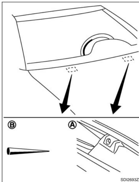
Veillez à ne pas obstruer le gicleur de lave-vitre (A). Le lave-vitre de pare-brise risque de ne pas fonctionner correctement. Si le gicleur est obstrué, retirez tout résidu à l'aide d'une aiguille ou d'une épingle fine (B). Veillez à ne pas endommager le gicleur.
