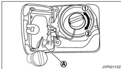
Le bouchon de réservoir à carburant est à cliquet. Tournez le bouchon dans le sens inverse des aiguilles d'une montre ① pour le retirer. Serrez le bouchon dans le sens des aiguilles d'une montre ② jusqu'à ce que plus de deux clics se produisent, une fois le réapprovisionnement en carburant effectué.
