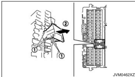
Pour réduire les pertes énergétiques de la batterie, le fusible-interrupteur de stockage étendu est désactivé à la sortie d'usine du véhicule. Avant la livraison de votre véhicule, l'interrupteur est enfoncé (activé) et devrait toujours rester activé.
