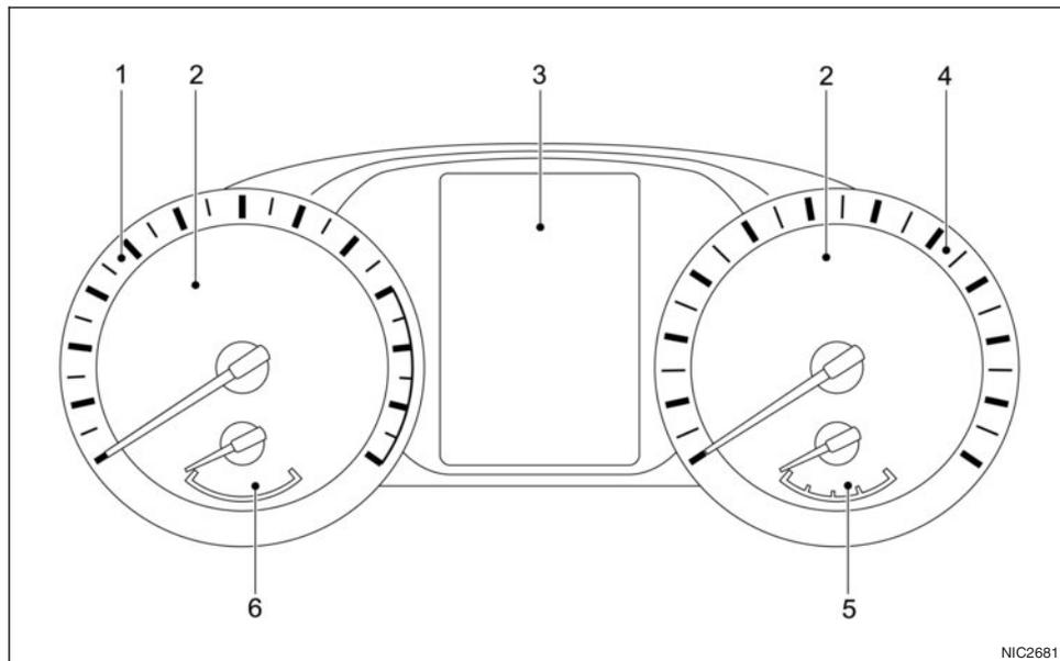
6. Jauge de température du liquide de refroidissement moteur (P. 2-58)
