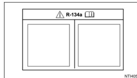
Sur la plus grande étiquette, le texte suivant est inscrit "[Contains fluorinated greenhouse gases]" "(Contient des gaz à effet de serre fluorés)."
