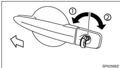
Pour verrouiller la portière, insérez la clé mécanique dans le cylindre de clé de portière et tournez-la vers l'avant du véhicule ①.
