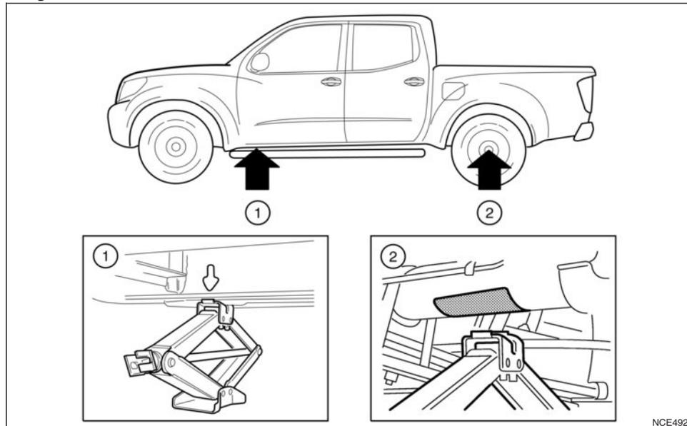
Pour les modèles avec suspension à ressort à lames
