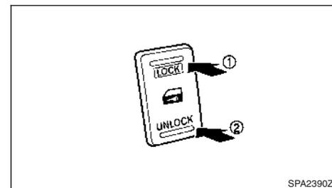
Le fait d'actionner la commande de verrouillage électrique de portière (située sur la portière conducteur) verrouille ou déverrouille toutes les portes.
