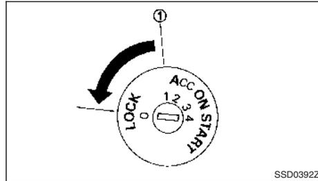
Le contact d'allumage comprend un dispositif anti-vol de blocage du volant.
