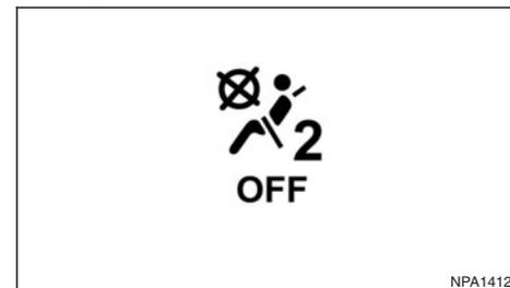
1. Désactivez l'airbag passager avant en insérant la clé de secours/mécanique dans la commande d'airbag passager avant (A), reportez-vous à "Clé mécanique" dans le chapitre "3. Vérifications et réglages avant démarrage" et "Témoin d'état d'airbag passager avant (selon modèles)" plus loin dans ce chapitre. Placez le contact d'allumage sur la position **ON** et assurez-vous que le témoin d'état d'activation de l'airbag avant s'allume sur la console centrale.
