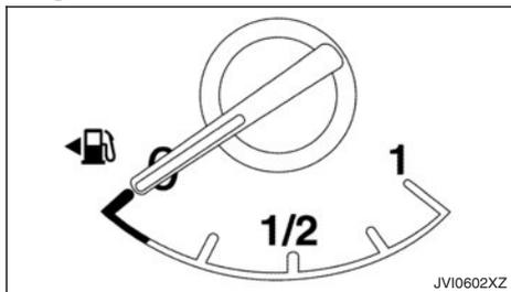
La jauge à carburant indique le niveau approximatif de carburant dans le réservoir lorsque le contact d'allumage est positionné sur ON.
