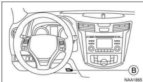
Lorsque la température du liquide de refroidissement moteur et la température extérieure sont basses, les bouches d'aération de plancher risquent de ne pas fonctionner. Cependant, il ne s'agit pas d'un dysfonctionnement. Une fois que la température du liquide de refroidissement augmente, le débit d'air provenant des sorties de plancher fonctionne normalement.
