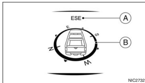
Cet affichage indique la direction dans laquelle le véhicule se déplace (A) ainsi qu'une boussole (B) autour de la représentation du véhicule.
