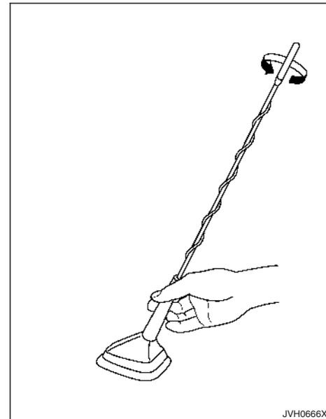
L'antenne peut être retirée si nécessaire.
