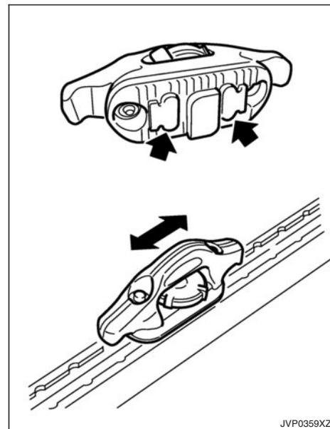
3. Positionnez le taquet de sorte que les picots sur le fond repose entièrement sur les crans de la glissière.
