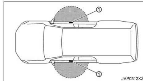
Les fonctions de la télécommande peuvent être utilisées uniquement lorsque cette dernière se trouve dans le périmètre de fonctionnement spécifié à partir du contact extérieur de poignée de portière ①.
