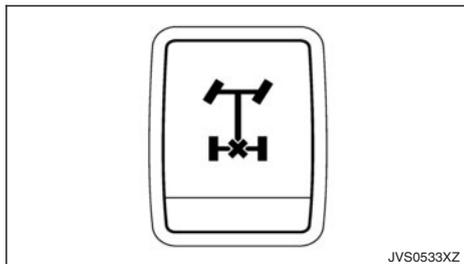
Le verrouillage de différentiel arrière a été conçu dans le but de transmettre uniformément la force motrice aux roues arrière gauche et droite.
