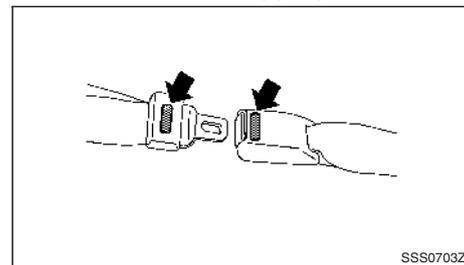
La boucle de ceinture de sécurité centrale (et/ou la languette, selon modèles) est identifiée par le repère <CENTER>. La languette de la ceinture de sécurité centrale peut être introduite uniquement dans la boucle de ceinture de sécurité centrale.
