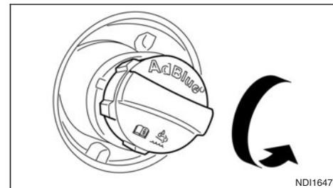
Le bouchon de réservoir de liquide AdBlue® est de type sans cliquet. Tournez le bouchon dans le sens inverse des aiguilles d'une montre ① pour le retirer. Vissez le bouchon dans le sens des aiguilles d'une montre ② jusqu'à ce qu'il soit serré.
