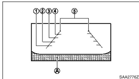
Les lignes de guidage, qui indiquent la largeur du véhicule et la distance des objets par rapport aux lignes de pare-chocs du véhicule (A) sont affichées sur le moniteur.
