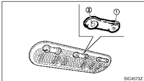
La commande de réglage de spot de lecture possède trois positions : ON ①, OFF ② et centrale.
