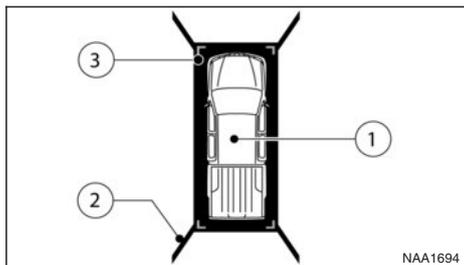
La vue à vol d'oiseau offre une vision du dessus du véhicule, ce qui permet de confirmer la position du véhicule et d'indiquer la manœuvre conseillée par rapport à un espace de stationnement.
