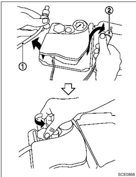
2. Retirez le flexible ① et la prise d'alimentation ② du compresseur d'air. Retirez le bouchon du porte-bouteille du compresseur d'air.
