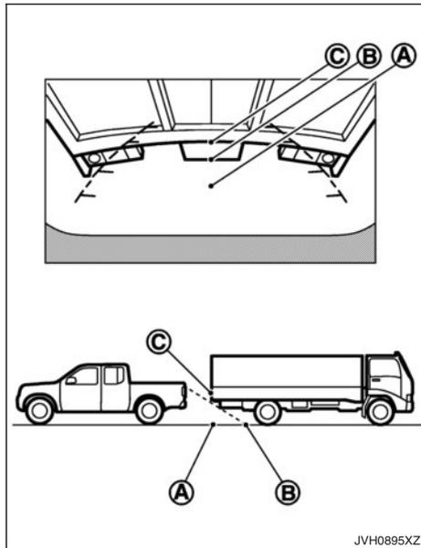
Sur l'écran, le point © paraît plus éloigné que le point ©. Le point © se situe cependant à la même distance que le point ©. Il est possible que le véhicule heurte l'objet lors d'une marche arrière jusqu'au point ©, si la partie proéminente de l'objet entre dans la course de manœuvre réelle du véhicule.
