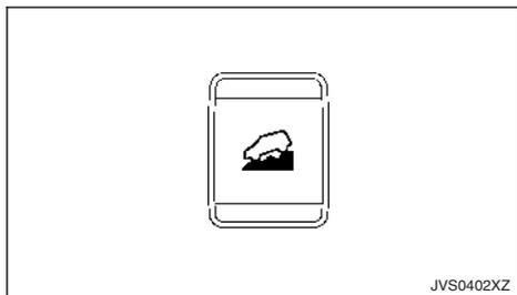
En cas de freinage supplémentaire nécessaire dans une pente raide, activez le système de contrôle de vitesse en descente en appuyant sur la commande de contrôle de vitesse en descente afin de la mettre en position de marche.
