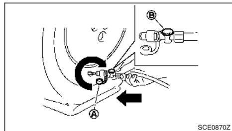
6. Retirez le bouchon de protection du flexible et vissez correctement le tuyau d'air (A) du compresseur sur la valve du pneu. Assurez-vous que la commande de compresseur d'air est désactivée (O) et que la valve de décharge (B) est correctement fermée, puis branchez la prise d'alimentation à la prise électrique du véhicule.
