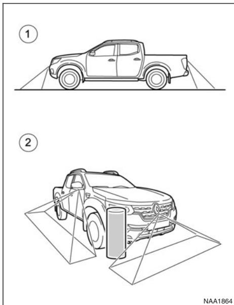
Il existe des zones dans lesquelles les objets ne sont pas affichés par le système. En vue avant ou arrière, un objet situé sous le pare-chocs ou sur le sol peut ne pas être affiché ①. En vue à vol d'oiseau, un objet de grande taille, situé à proximité de la limite de la zone d'affichage de la caméra n'apparaîtra pas sur le moniteur ②.
