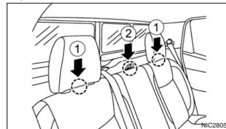
Le point d'ancrage est une boucle de sangle située sur la partie supérieure du dossier de siège central de deuxième rangée ②. Deux sangles identiques sont situées à l'arrière des sièges latéraux de 2ème rangée et sont uniquement conçues pour être utilisées comme boucles guide ①.
