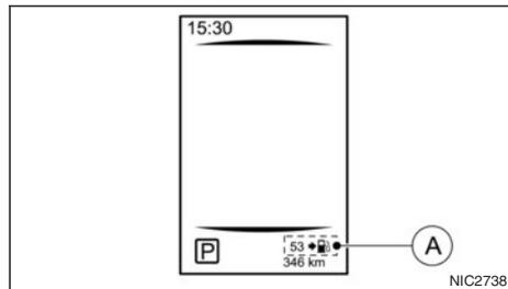
La fonction de distance pouvant être parcourue avant réservoir vide (dte)  $\text{\textcircled{A}}$  vous fournit une estimation de la distance pouvant être parcourue avant un réapprovisionnement en carburant. La distance pouvant être parcourue avant réservoir vide (dte) est constamment recalculée en fonction de la quantité de carburant restant dans le réservoir et de la consommation de carburant réelle du véhicule.
