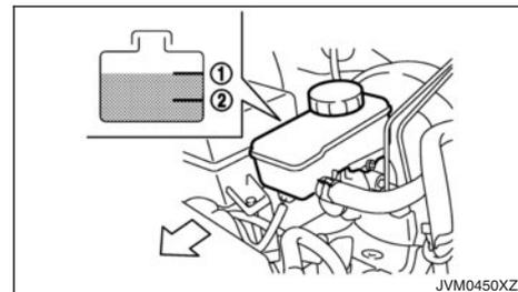
Vérifiez le niveau de liquide dans le réservoir. Si le niveau de liquide est en dessous du repère MIN ②, ajoutez du liquide jusqu'au repère MAX ①.
