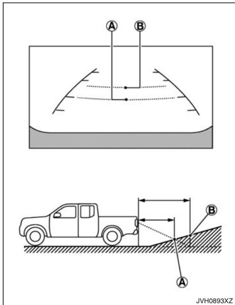
Lorsque vous effectuez une marche arrière en montée, les lignes de distance et les lignes de largeur du véhicule semblent plus proches qu'elles ne le sont en réalité. Par exemple, l'affichage indique une distance de 1 m (3 ft) par rapport au point **A**, mais la distance de 1 m (3 ft) correspond en réalité au point
