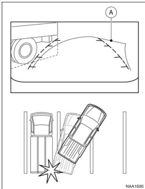
Sur l'écran, les lignes de manœuvre conseillée (A) ne touchent pas l'objet. Cependant, il est possible que le véhicule heurte l'objet si la partie proéminente entre dans la trajectoire de déplacement réelle du véhicule.
