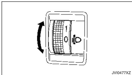
La commande de réglage des faisceaux de phares fonctionne lorsque le contact d'allumage est placé sur la position **ON** et que la commande de phares se trouve sur la position **ON**, de manière à permettre le réglage de l'axe des faisceaux de phares en fonction des conditions de conduite.
