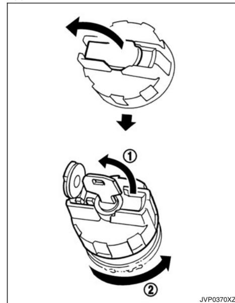
Pour ouvrir le bouchon de remplissage de carburant, tournez la clé dans le sens inverse des aiguilles d'une montre ①.
