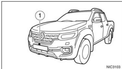
Le système de freinage d'urgence actif utilise un capteur radar ① situé à l'avant du véhicule pour mesurer la distance par rapport au véhicule qui précède dans la voie de circulation.
