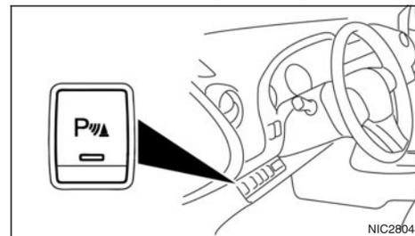
La commande de désactivation du système de capteur d'aide au stationnement (sonar) située sur le tableau de bord permet au conducteur d'activer ou de désactiver le système de capteur d'aide au stationnement (sonar). Pour activer ou désactiver le système de capteur d'aide au stationnement (sonar), le contact d'allumage doit être placé sur la position **ON**.
