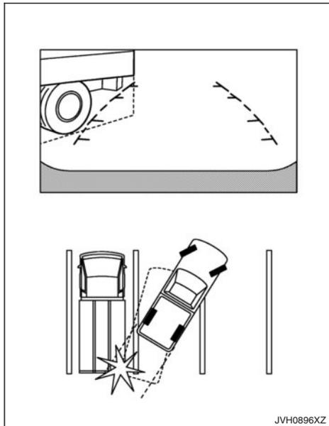
Il est possible que sur l'affichage le véhicule semble pouvoir éviter l'objet de justesse. Cependant, le véhicule risque de heurter l'objet si la partie proéminente entre dans la course de manœuvre réelle du véhicule.
